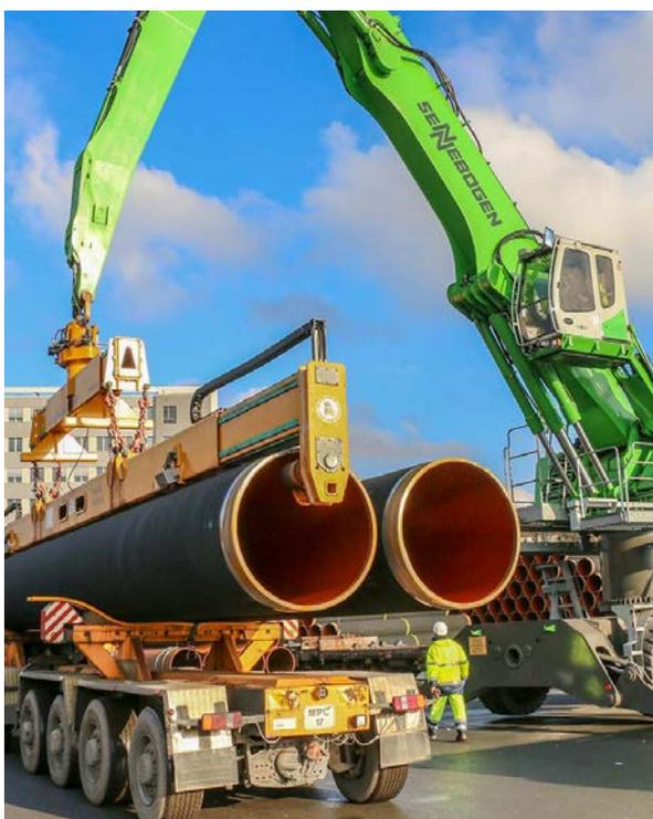
I caricatori Sennebogen possono essere equipaggiati con una vasta gamma di accessori per ottimizzare l'efficienza e la versatilità delle operazioni. Benne bivalve e polipi idraulici di diverse dimensioni e capacità, cesoie per rottami e piastre magnetiche specifiche per ogni lavorazione.
