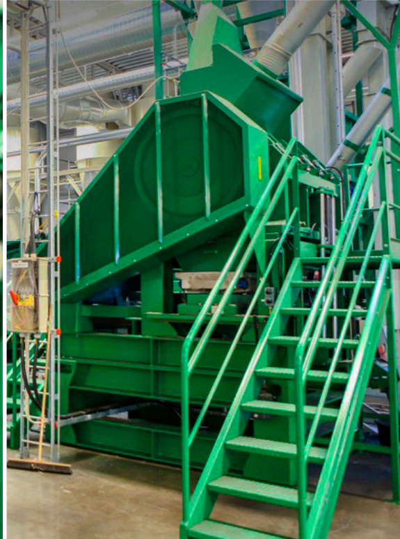
LINEA RICICLO PNEUMATICI 1 doppia linea (6 T/h) o 2 linee (3 T/h)
