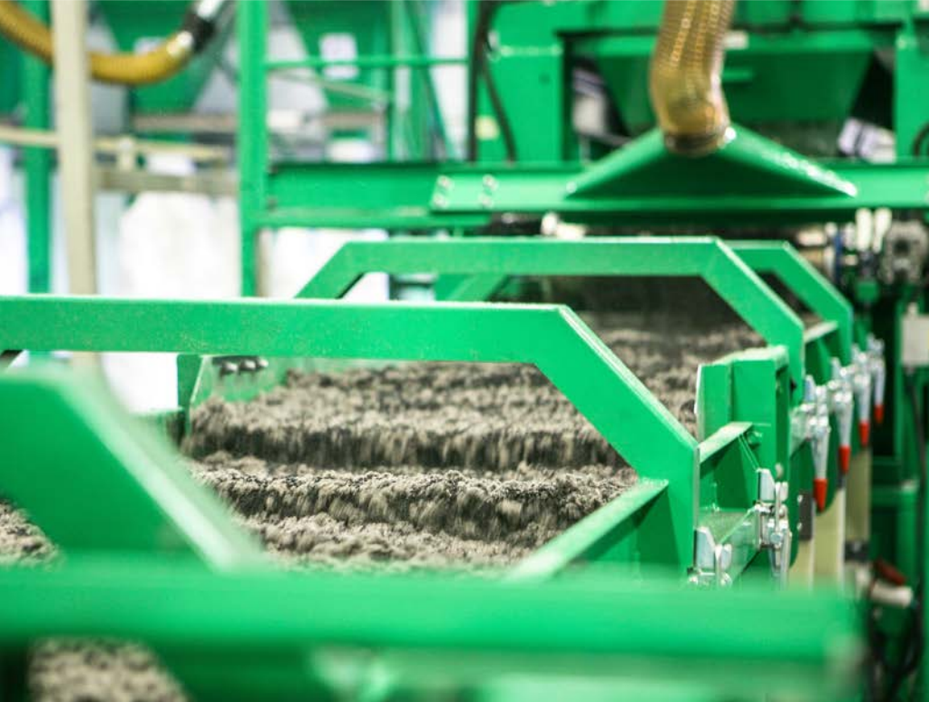
LINEA RICICLO PNEUMATICI 1 doppia linea (6 T/h) o 2 linee (3 T/h)
