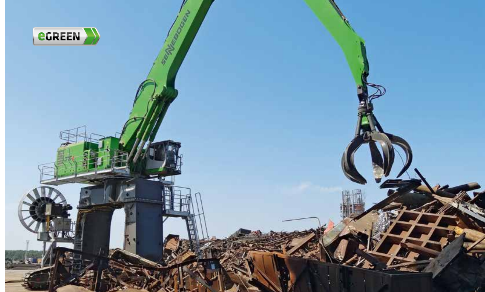
875 R portal electro - with orange peel grab - scrap handling; Russia 875 R Portal Elektro - mit Mehrschalengreifer - Schrottschlag; Russland
