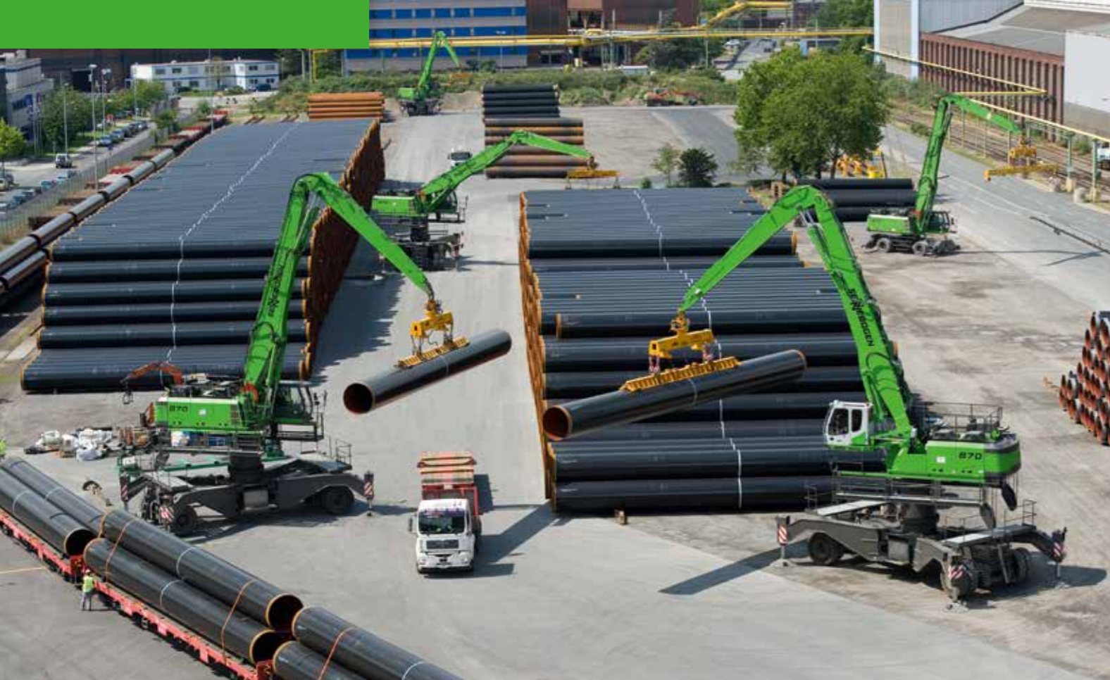
870 M - with vacuum lifting device - unloading a truck and train; Germany 870 M - mit Vakuumtraverse - Entladung eines Zuges und LKW; Deutschland
