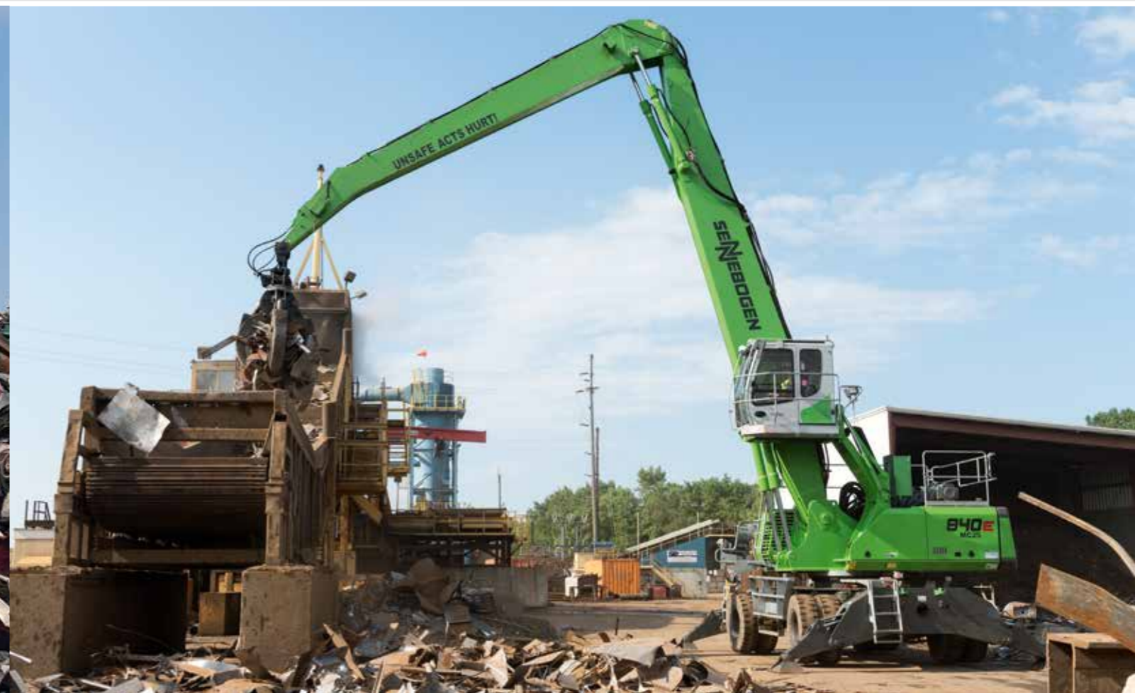
840 M - feeding shredder - orange peel grab; USA 840 M - Schredderbeschickung - Mehrschalengreifer; USA
