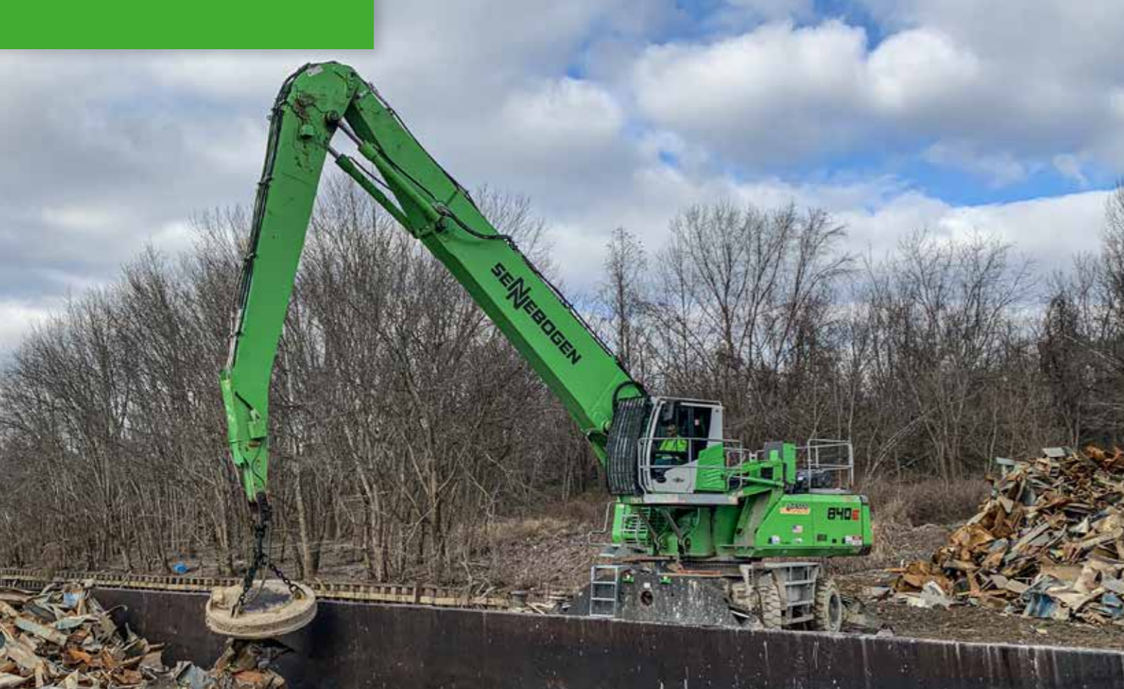
840 M - with scrap magnet - scrap handling; USA 840 M - mit Schrottmagnet - Schrottschlag; USA
