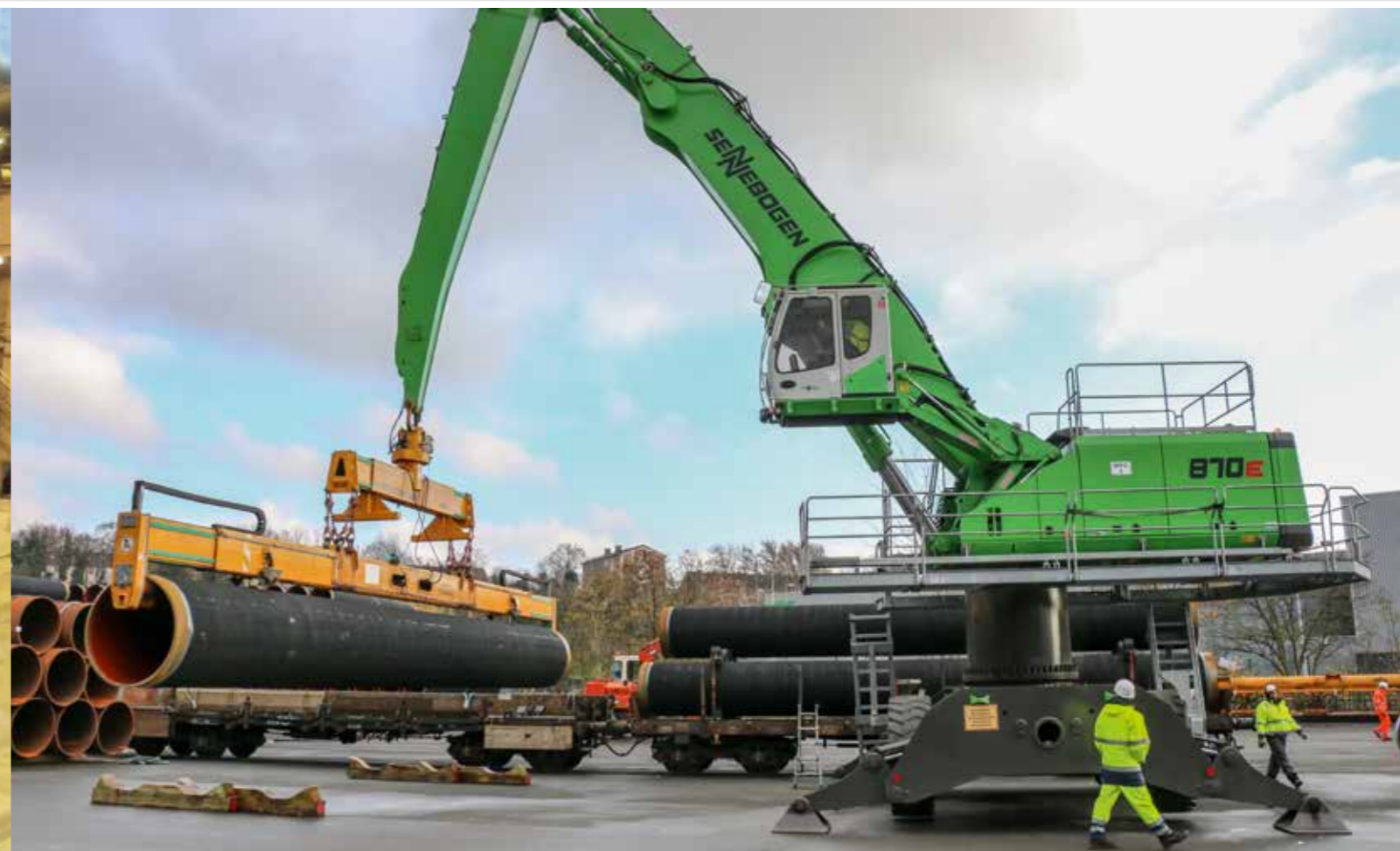
870 M - with spreader- handling of steel pipes; Germany 870 M - mit Traverse - Umschlag von Stahlrohren; Deutschland
