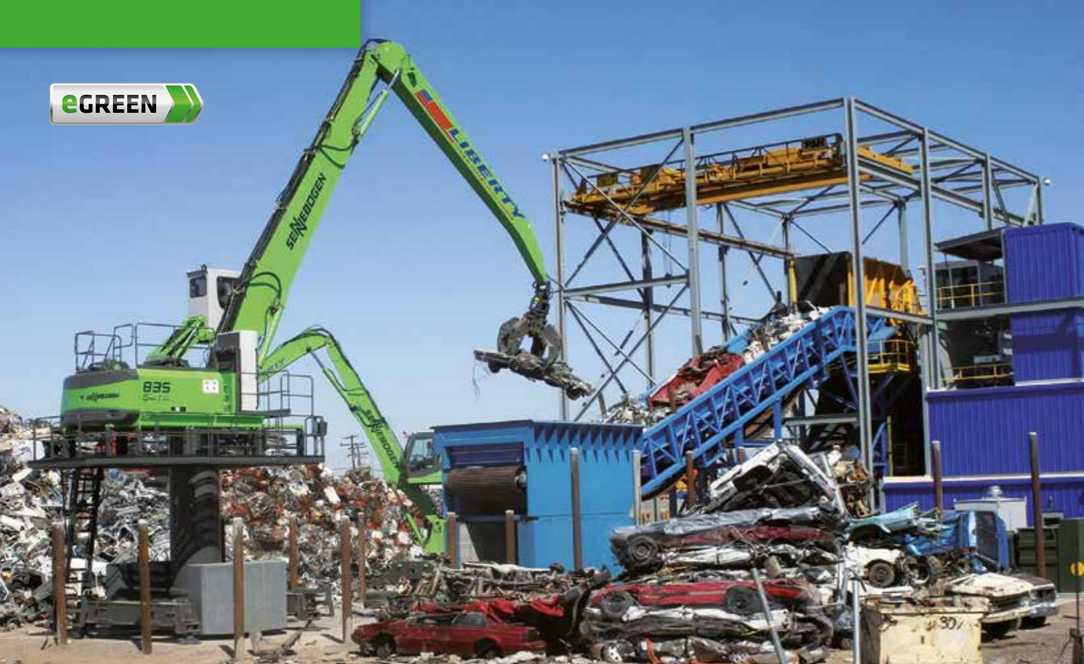
835 Spezial - 4 m Pylon - Sonderausüstung K20 - 600 Liter Mehrschalengreifer; USA 835 special - 4 m pylon - special equipment K20 - 600 litre orange-peel grab; USA
