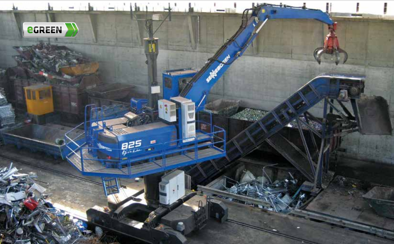
825 A special - electro on rail undercarriage - 2.5 m pylon - equipment K12 - 600 litre orange peel grab; Switzerland 825 A Spezial - Elektro auf Schienenunterwagen - 2,5 m Pylon - Ausrüstung K12 - 600 Liter Mehrschalengreifer; Schweiz
