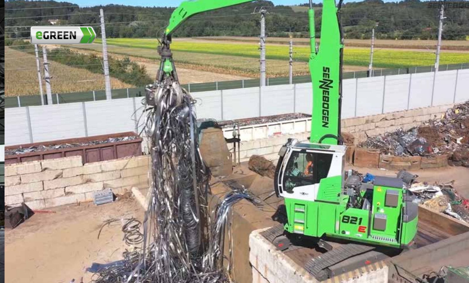
821 R electro - scrap recycling with orange peel grab; Austria 821 R Elektro - Schrottreycling mit Mehrschalengreifer; Österreich
