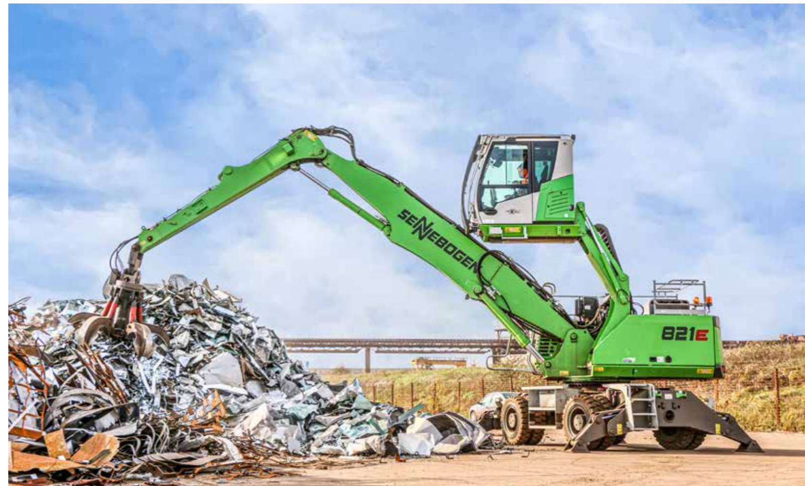
821 M - with orange peel grab - scrap handling; Romania 821 M - mit Mehrschalengreifer - Schrottschlag; Rumänien
