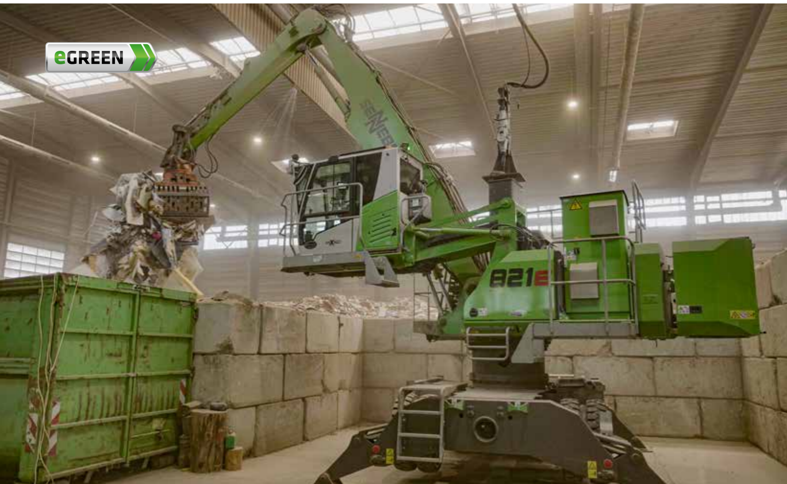
821 M - with sorting grab - inside a hall with ceiling power supply; Germany 821 M - mit Sortiergreifer - Halleneinsatz mit Deckenstromzuführung; Deutschland
