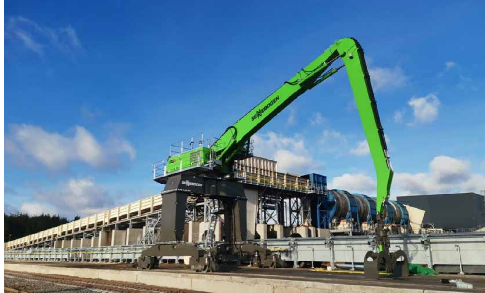
850 rail gantry - with sorting grab; USA 850 Schienenportal - mit Sortiergreifer; USA
