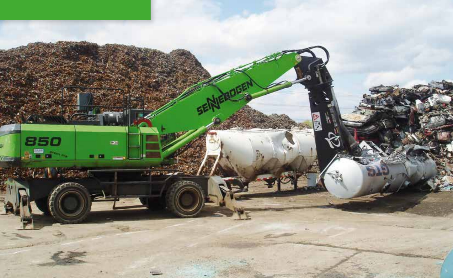
850 M - special equipment - scrap shears; USA 850 M - Sonderausrüstung - Schrottschere; USA
