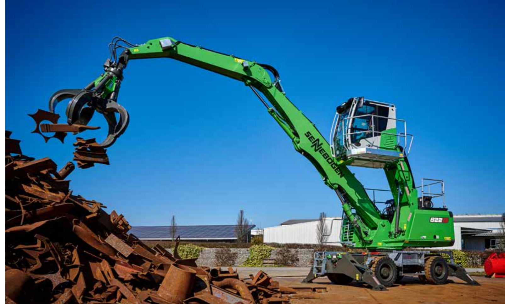
822 M - with orange peel grab - scrap handling; Germany 822 M - mit Mehrschalengreifer - Schrottschlag; Deutschland
