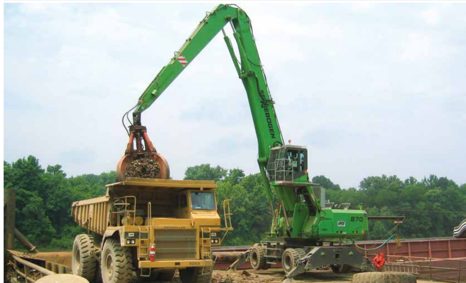
870 M - equipment K18 - 3.000 litre orange-peel grab; USA 870 M - Ausrüstung K18 - 3.000 Liter Mehrschalengreifer; USA
