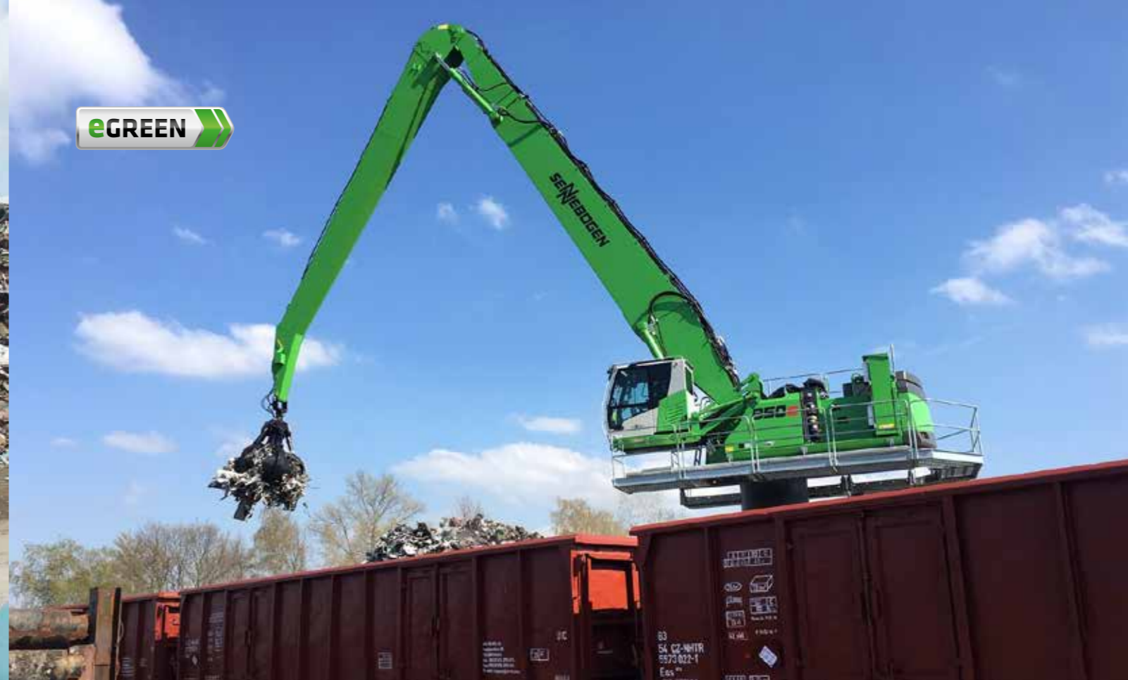
850 special electro - with orange peel grab - scrap handling; USA 850 Spezial Elektro - mit Mehrschalengreifer - Schrotttumschlag; USA
