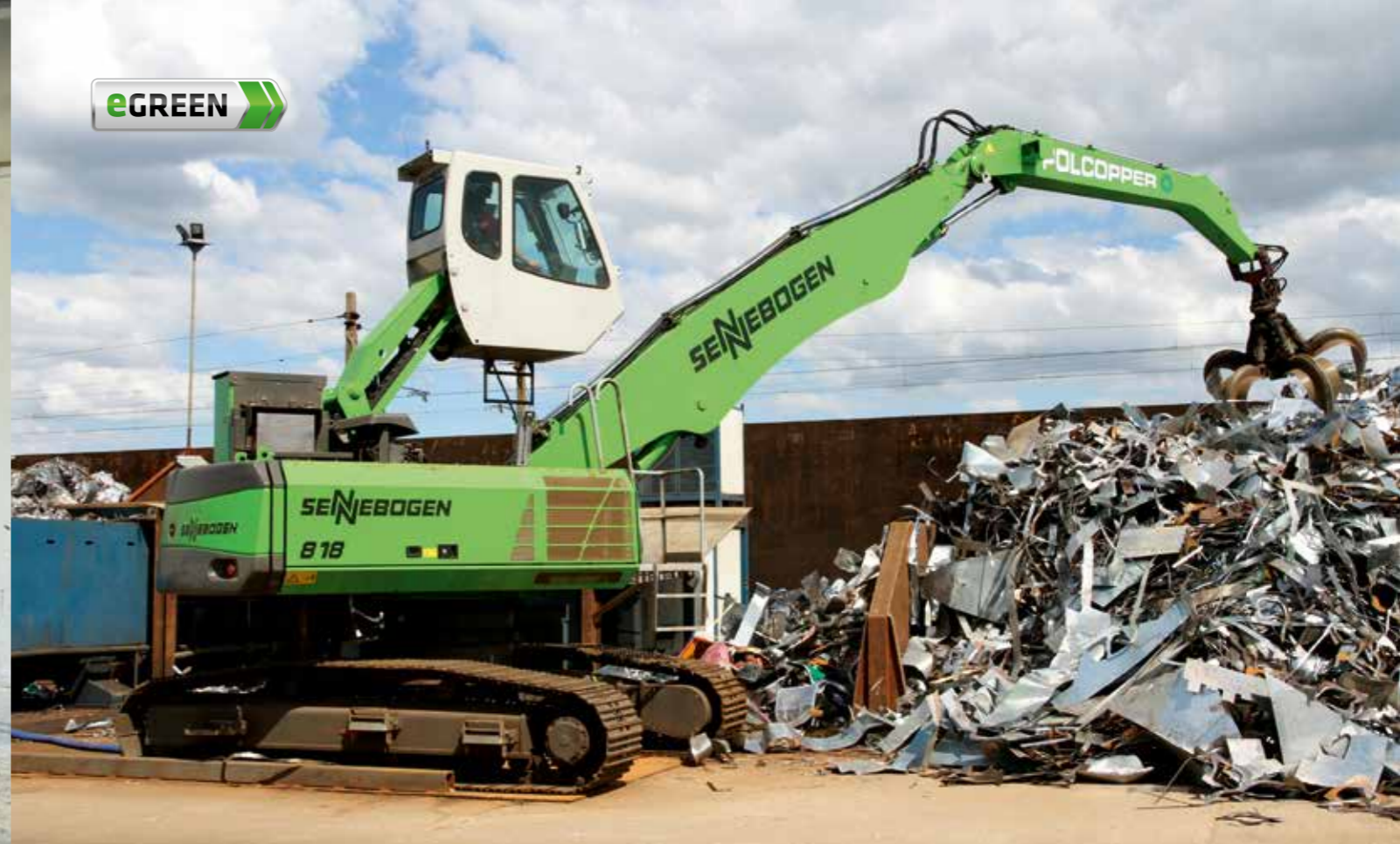
818 R electro - with orange peel grab - loading of a shredder; Poland 818 R Elektro - mit Mehrschalengreifer - Beschickung eines Shredders; Polen
