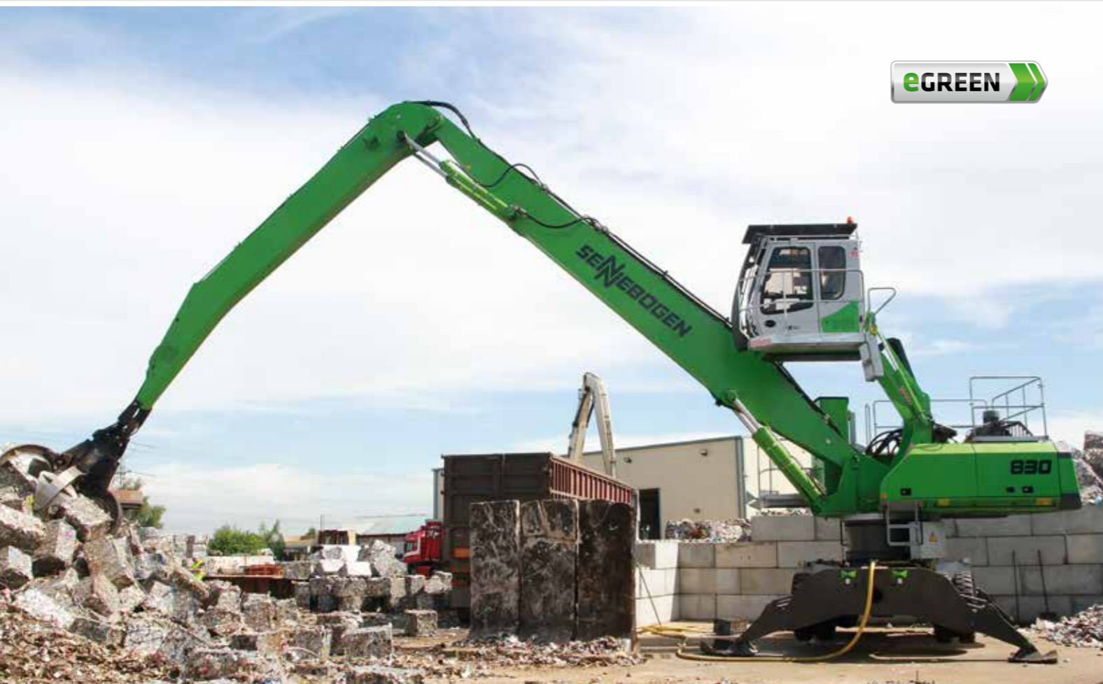
830 M electro - with orange peel grab - scrap handling; Great Britain 830 M Elektro - mit Mehrschalengreifer - Schrottschlag; Großbritannien
