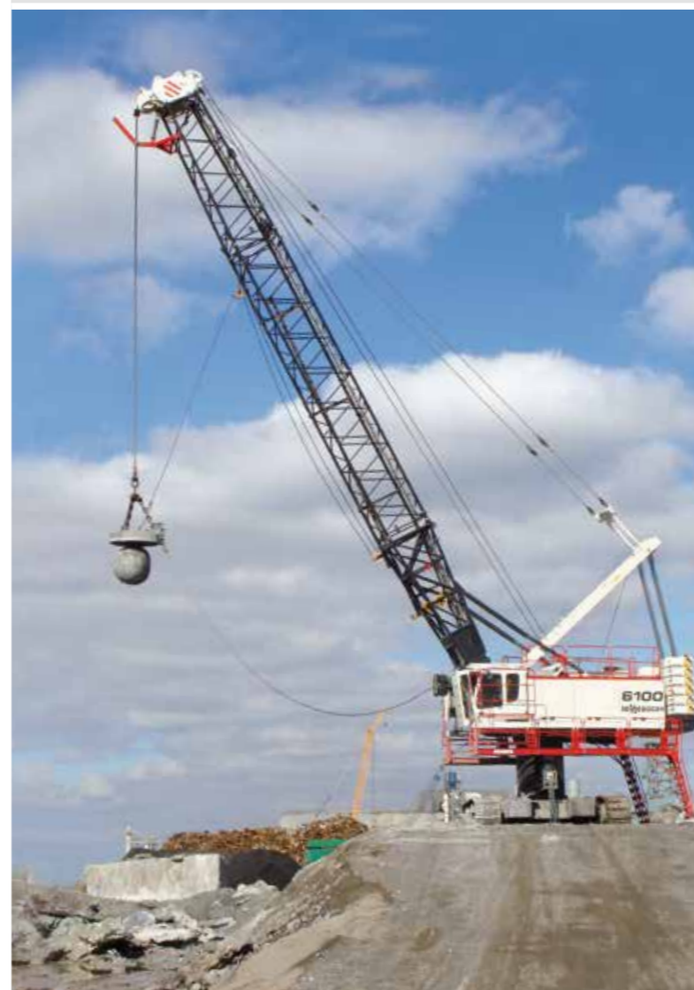
6100 HD - 24,3 m boom length - slag crushing with magnet plate; USA 6100 HD - 24,3 m Auslegerlänge - Schlackezerkleinerung mit Magnetplatte; USA
