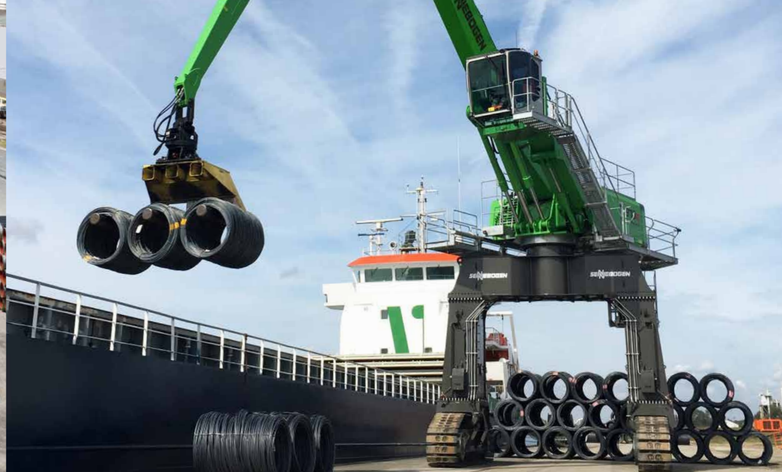
870 R crawler gantry- coil handling in a port; Belgium 870 R Raupenportal - Coil-Handling im Hafen; Belgien
