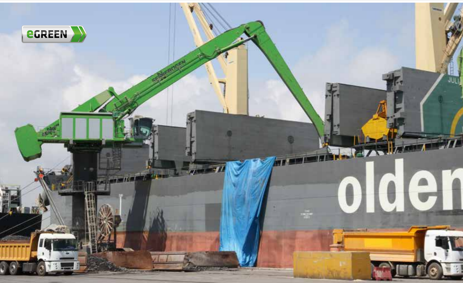
880 EQ - with clamshell grab - port handling; Turkey 880 EQ - mit Zweischalengreifer - Hafenumschlag; Türkei
