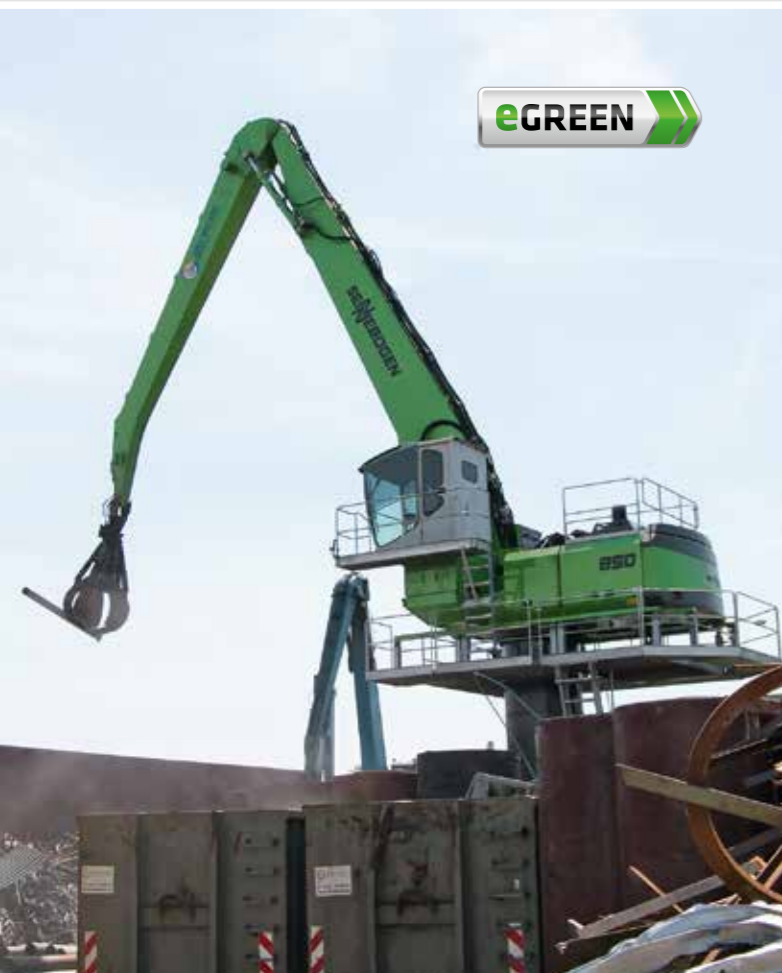
850 R special electro - with orange peel grab - loading of a container; Germany 850 R Spezial Elektro - mit Mehrschalengreifer - Befüllung von Containern; Deutschland
