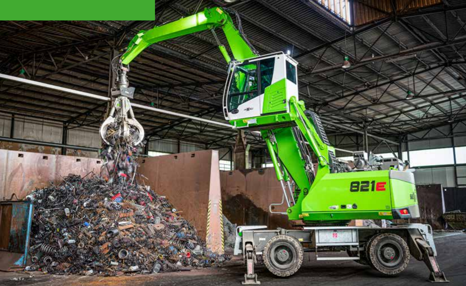
821 M - with orange peel grab - scrap handling; Germany 821 M - mit Mehrschalengreifer - Schrottschlag; Deutschland
