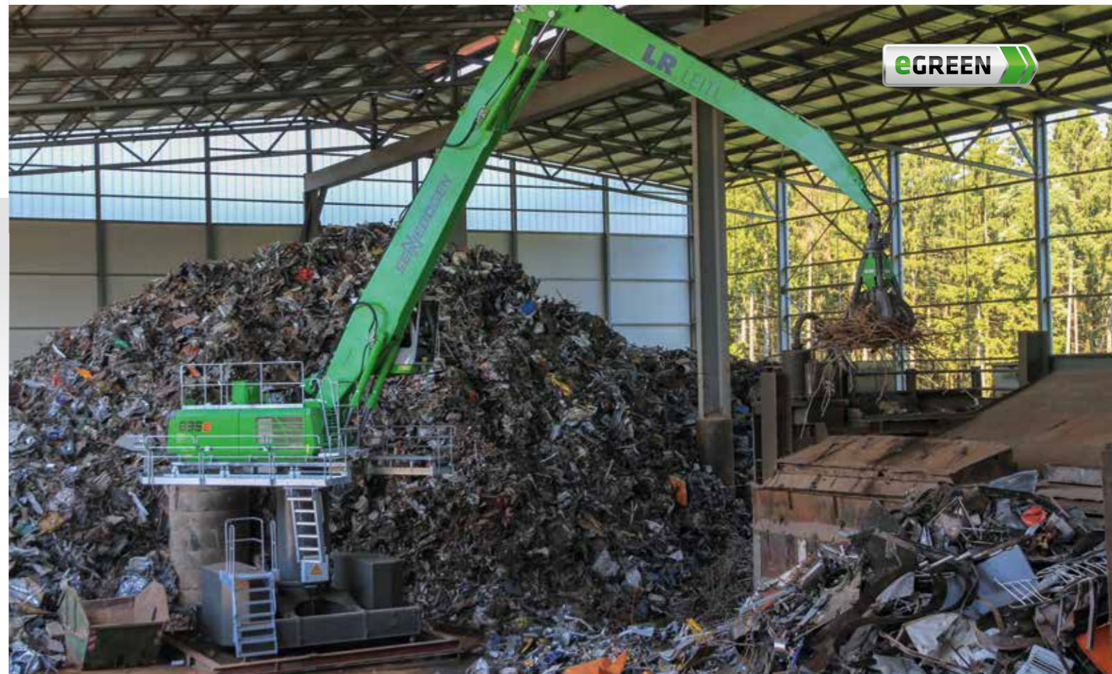
835 special electro - working indoor, loading of a scrap shear; Germany 835 Spezial Elektro - Halleneinsatz, Beschickung einer Schrottschere; Deutschland
