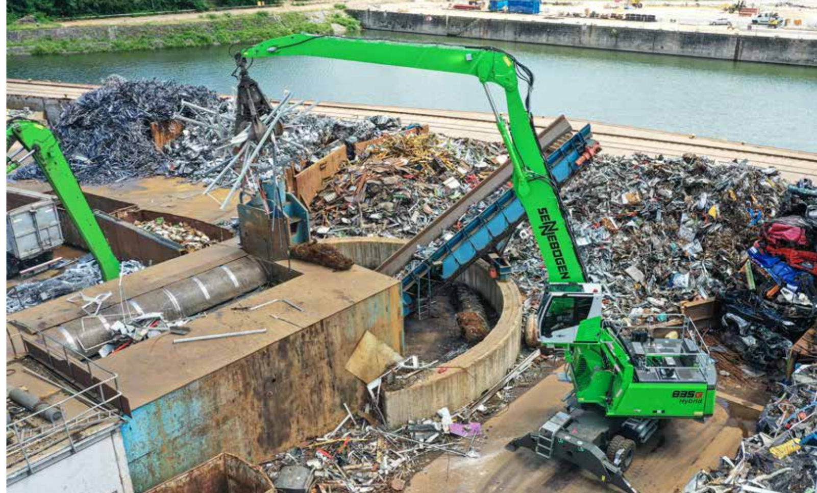
835 M - with orange peel grab - loading of a scrap shear; Germany 835 M - mit Mehrschalengreifer - Beschickung einer Schrottschere; Deutschland
