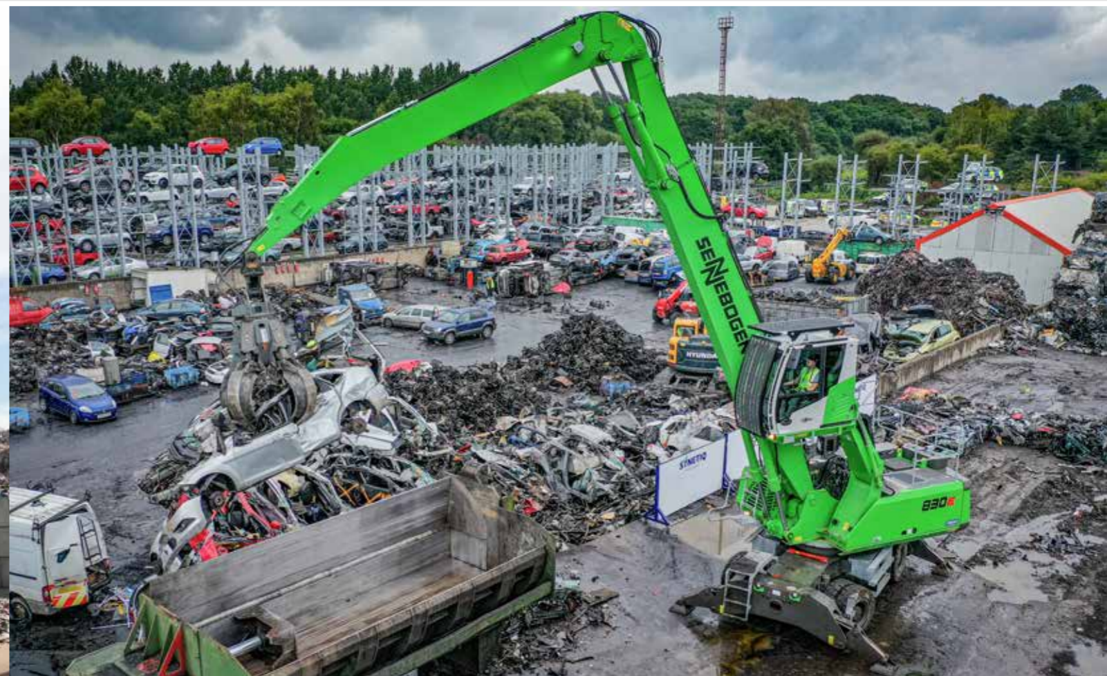
830 M - with orange peel grab - car recycling; United Kingdom 830 M - mit Mehrschalengreifer - Autorecycling; Vereinigtes Königreich
