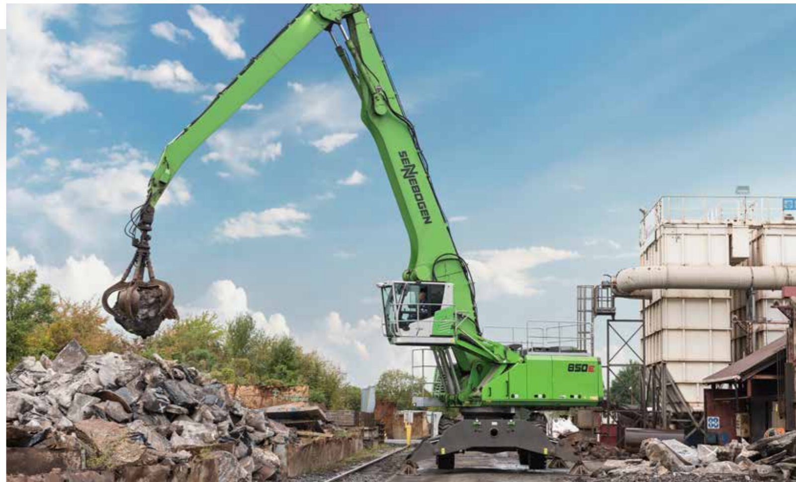
850 M - with orange peel grab - handling of steel skulls; Germany 850 M - mit Mehrschalengreifer - Umschlag von Stahlbären; Deutschland
