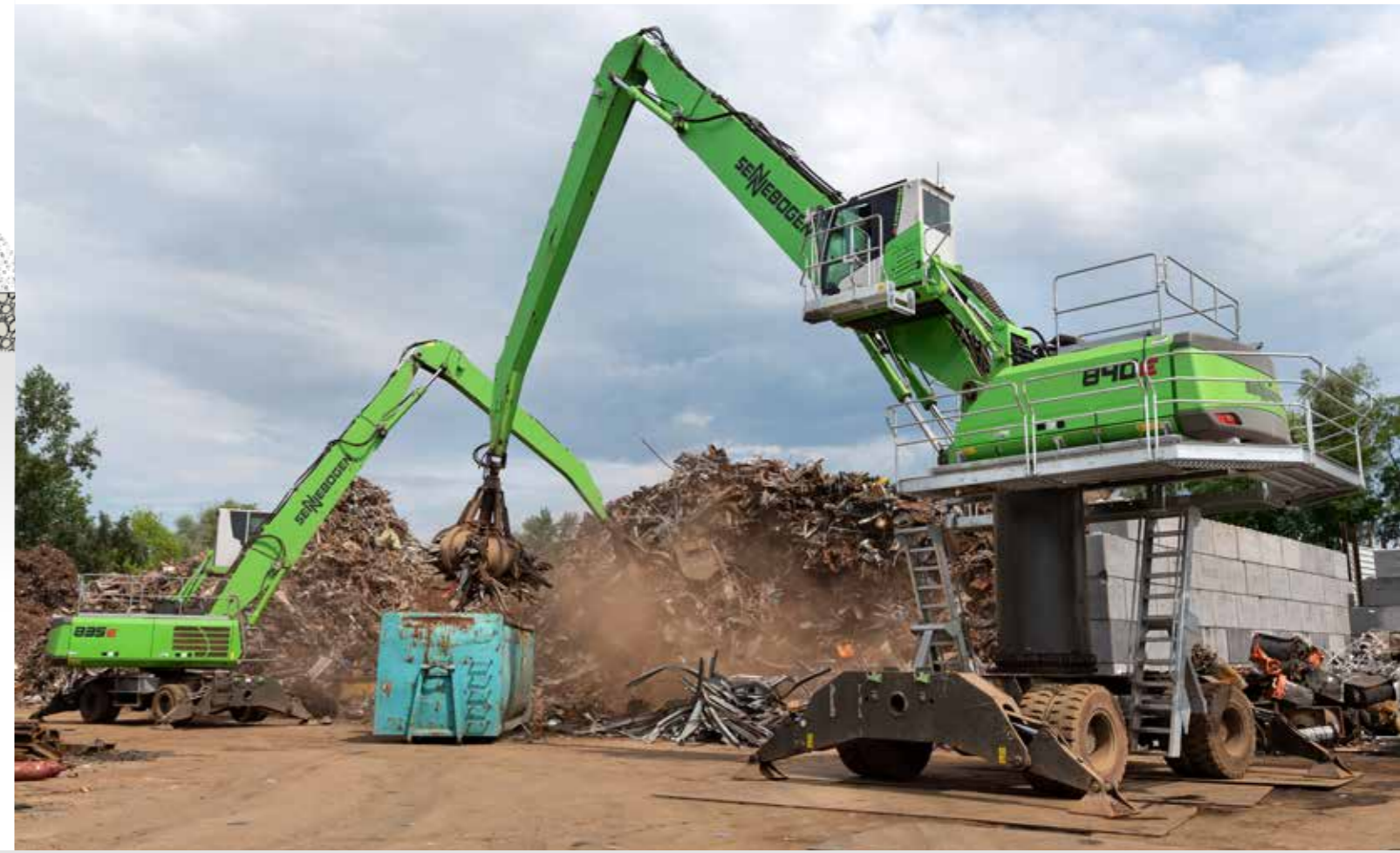
840 M special - with orange peel grab - scrap handling; Germany 840 M Spezial - mit Mehrschalengreifer - Schrottschlag; Deutschland
