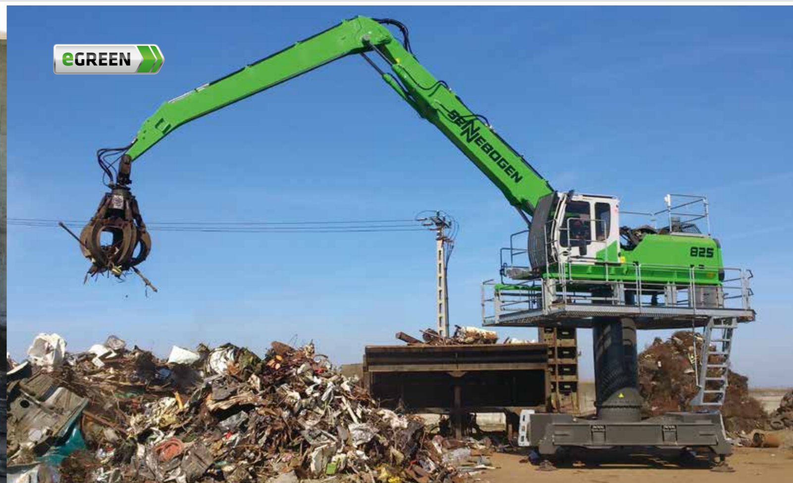
825 stationary electro with pylon - with orange peel grab - loading of a scrap shear; Hungary 825 Stationär Elektro mit Pylon - mit Mehrschalengreifer - Beschickung Schrottschere; Ungarn
