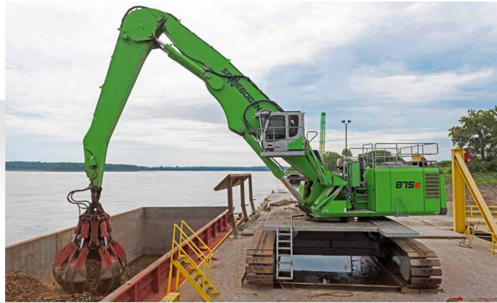
875 R - with orange peel grab - ship loading; USA 875 R - mit Mehrschalengreifer - Schiffsbeladung; USA
