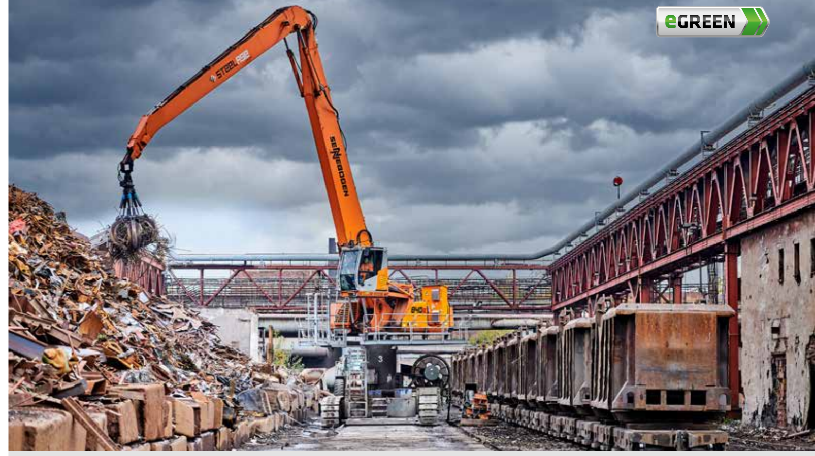
840 R special electro - with orange peel grab - loading of wagons; Czech Republic 840 R Spezial Elektro - mit Mehrschalengreifer - Beladung von Waggons; Tschechien
