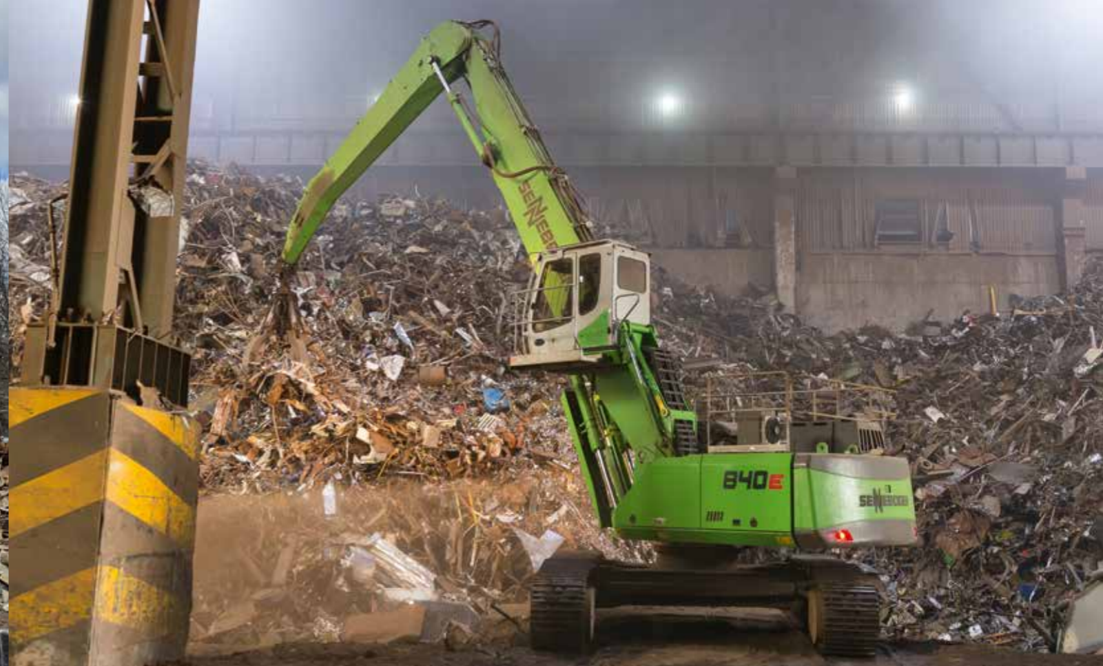
840 R - equipment K18 - steel works - 800 litre orange-peel grab; Turkey 840 R - Ausrüstung K18 - Stahlwerk - 800 Liter Mehrschalengreifer; Türkei
