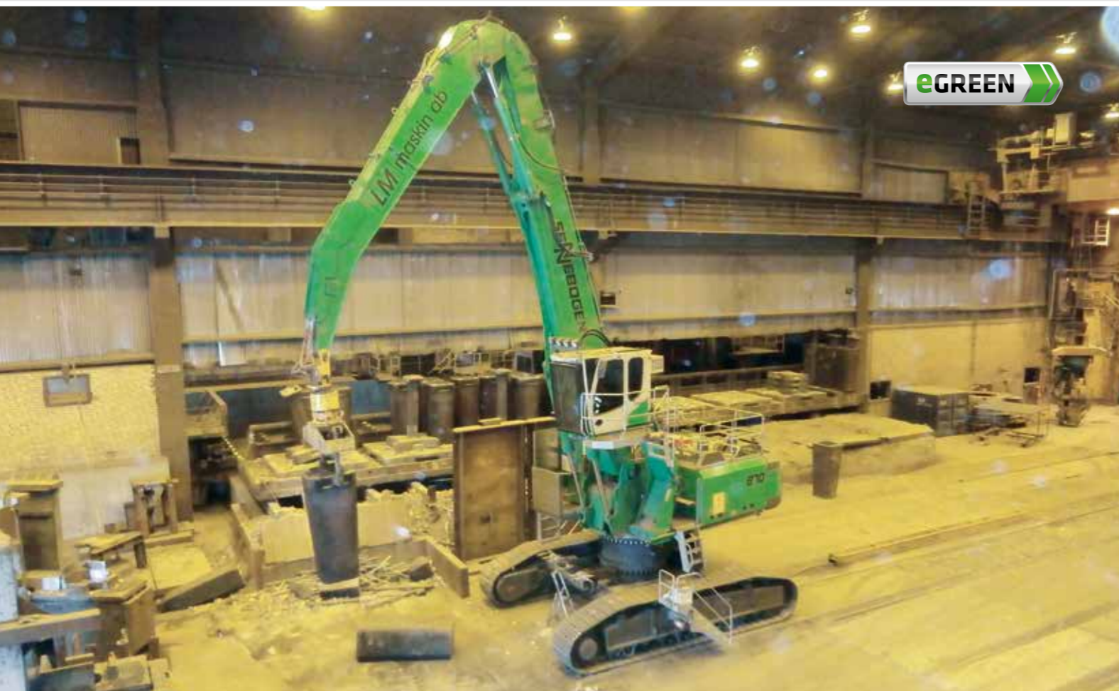
870 R - with molds claw - handling of foundry molds; Sweden 870 R - mit Kokillengreifer - Umschlag von Gussformen; Schweden
