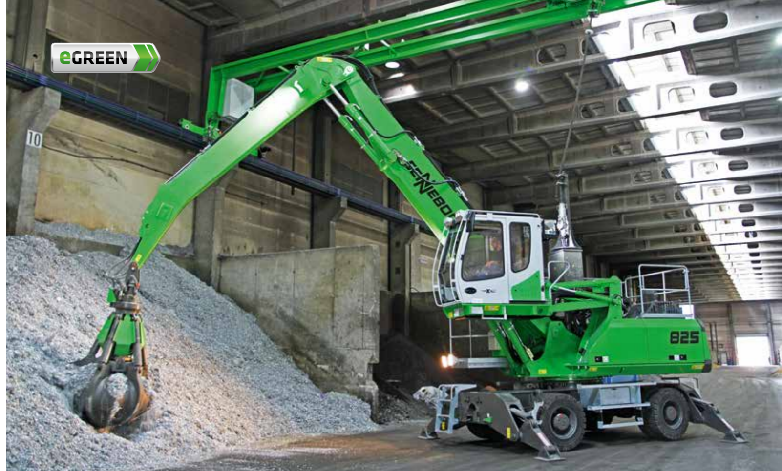
825 M electro - with orange peel grab - inside a hall with ceiling power supply; Germany 825 M Elektro - mit Mehrschalengreifer - Halleneinsatz mit Deckenstromzuführung; Deutschland
