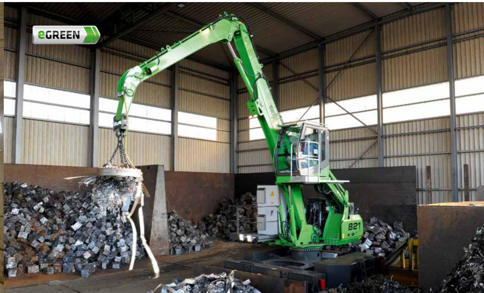
821 stationary electro - with scrap magnet - scrap handling; Germany 821 Stationär Elektro - mit Schrottmagnet - Schrottschlag; Deutschland
