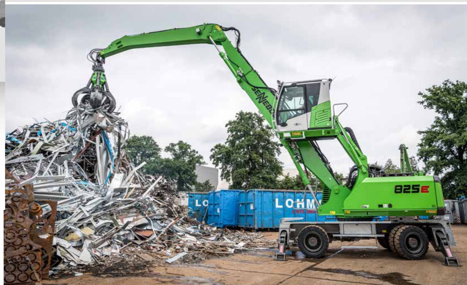
825 M - with orange peel grab - scrap recycling; Germany 825 M - mit Mehrschalengreifer - Schrottreycling; Deutschland
