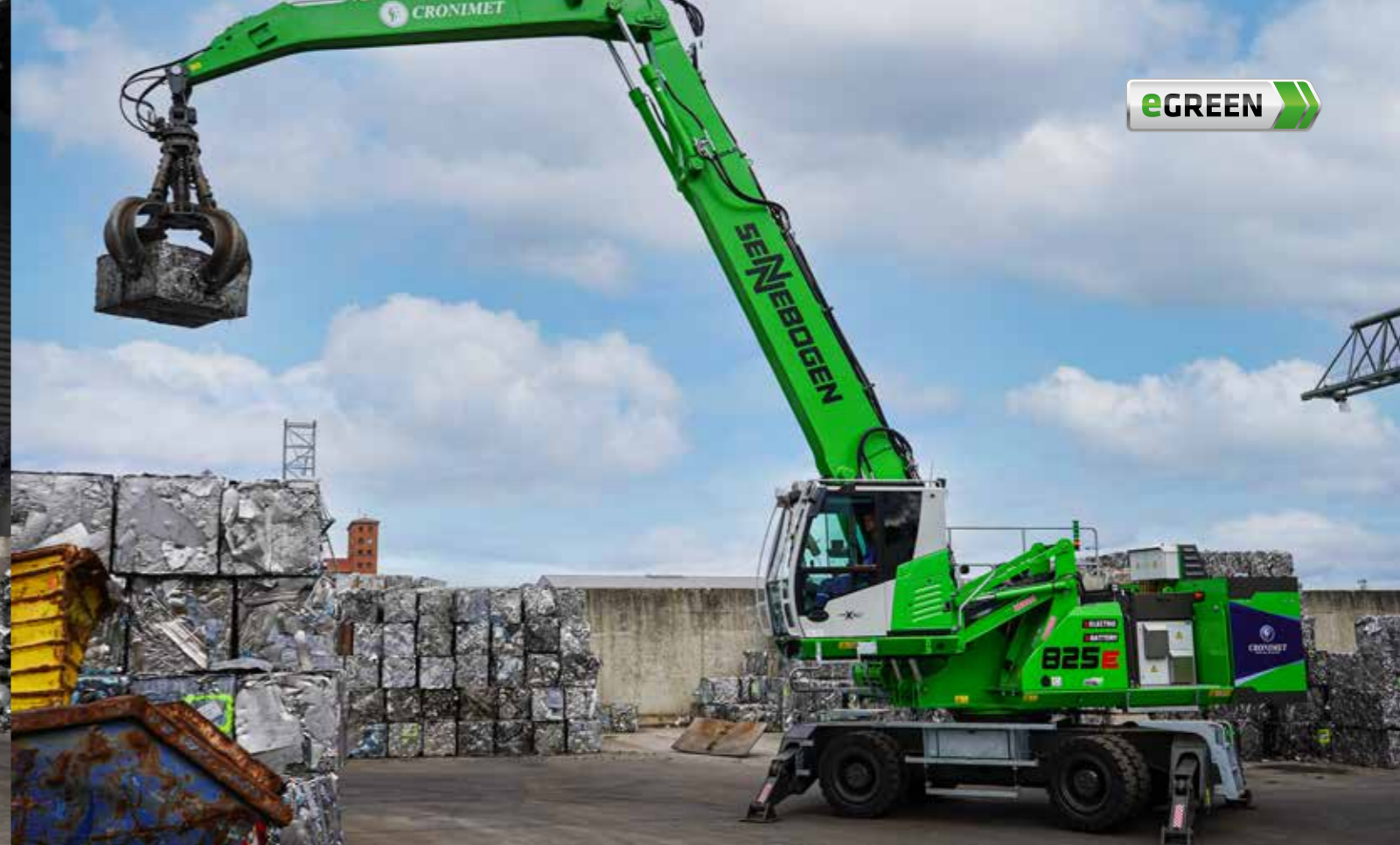
825 Electro Battery - with orange peel grab - scrap recycling; Germany 825 Electro Battery - mit Mehrschalengreifer - Schrottreycling; Deutschland
