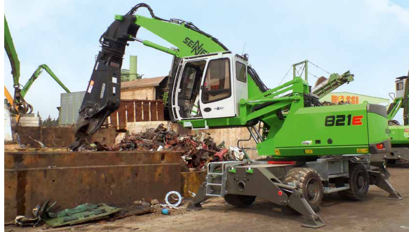
821 M - with 4 t scrap shears - shearing of scrap; France 821 M - mit 4 t Schrottschere - Zerkleinern von Schrott; Frankreich
