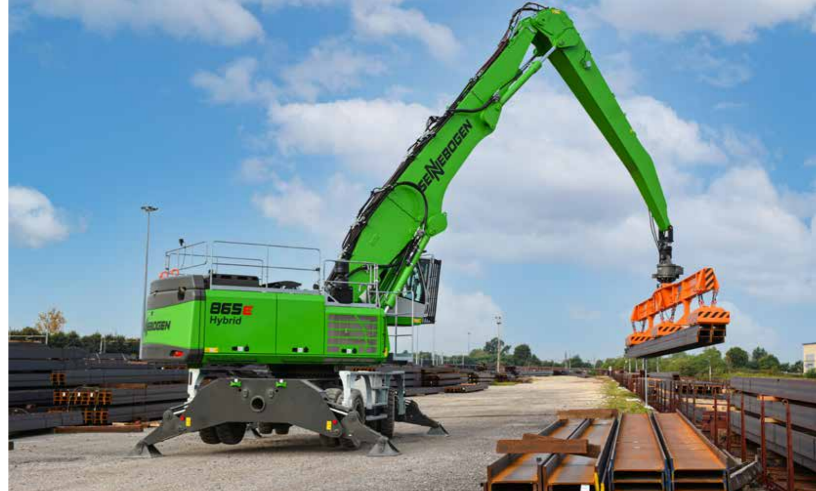
865 M - with magnetic lifting beam - steel handling; Italy 865 M - mit Magnettraverse - Stahlumschlag; Italien
