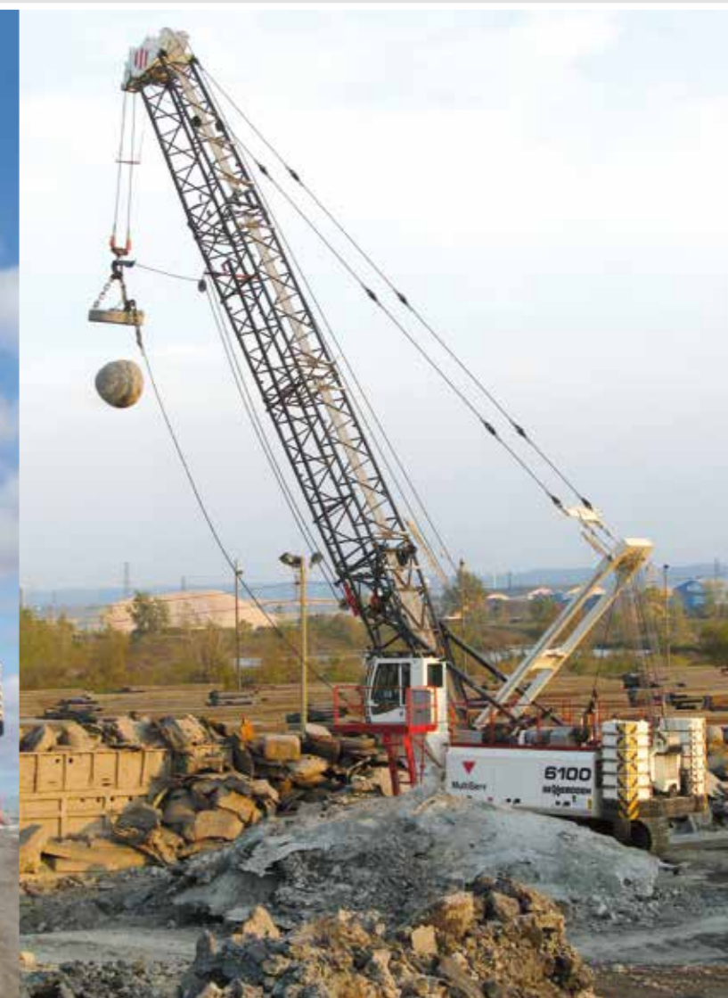
6100 HD - 24,3 m boom length - slag crushing with magnet plate; Canada 6100 HD - 24,3 m Auslegerlänge - Schlackezerkleinerung mit Magnetplatte; Kanada
