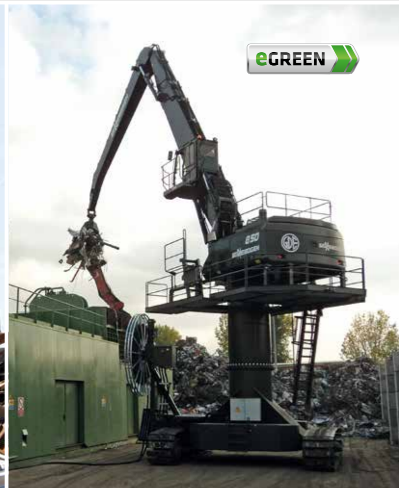
850 R special electro - with orange peel grab - loading of a scrap shearer; France 850 R Spezial Elektro mit Mehrschalengreifer - Beschickung einer Schrottschere; Frankreich
