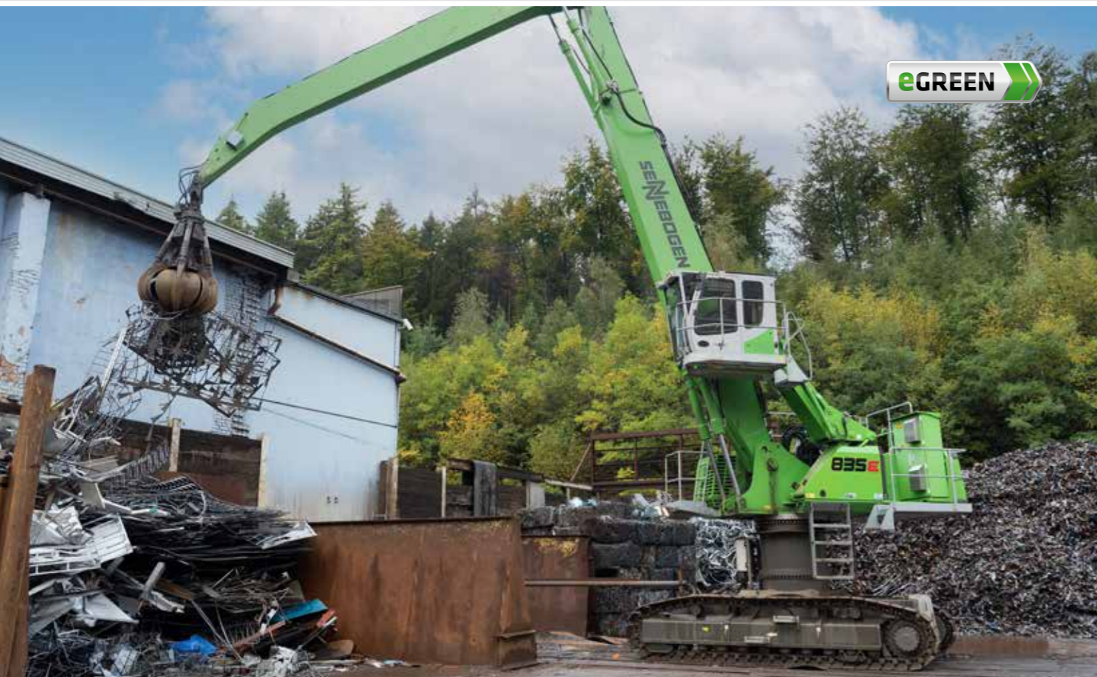
835 R special electro - with orange peel grab; Germany 835 R Spezial Elektro - mit Mehrschalengreifer; Deutschland
