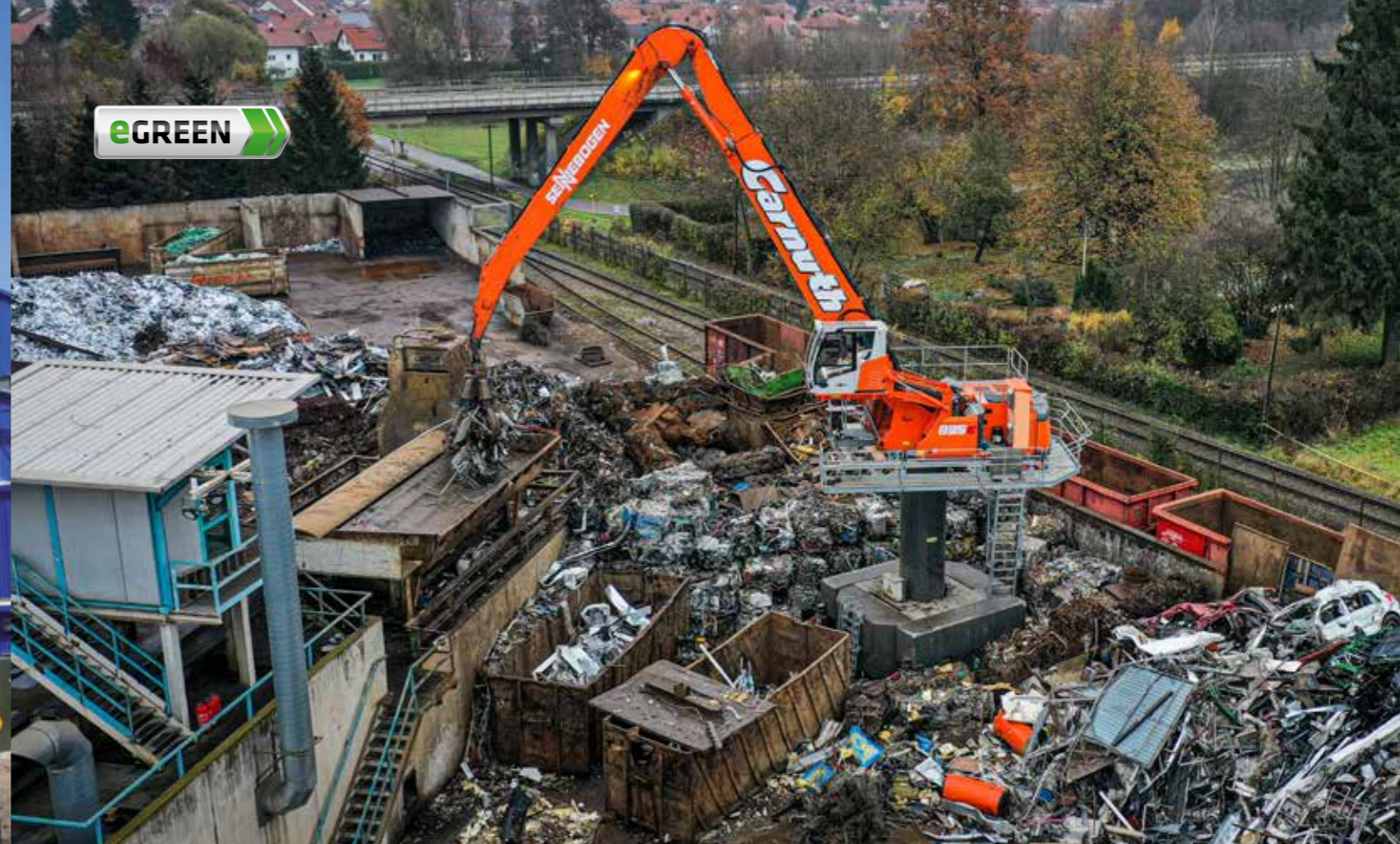
835 stationary electro with pylon - with orange peel grab - scrap handling; Germany 835 Stationär Elektro mit Pylon - mit Mehrschalengreifer - Schrottschlag; Deutschland
