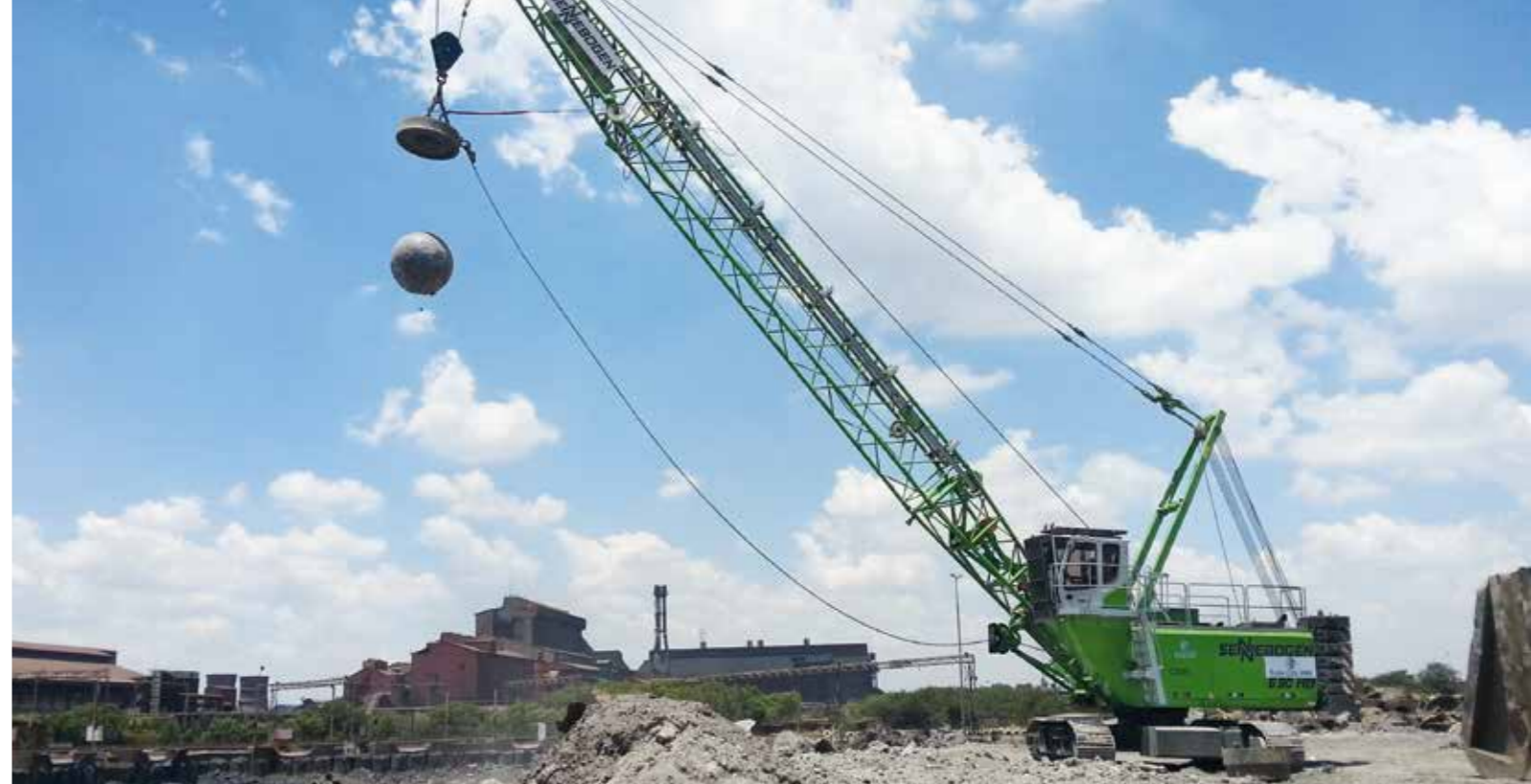
690 HD - with dropball - smashing of slag; South Africa 690 HD - mit Dropball - Zertrümmern von Schlacke; Südafrika
