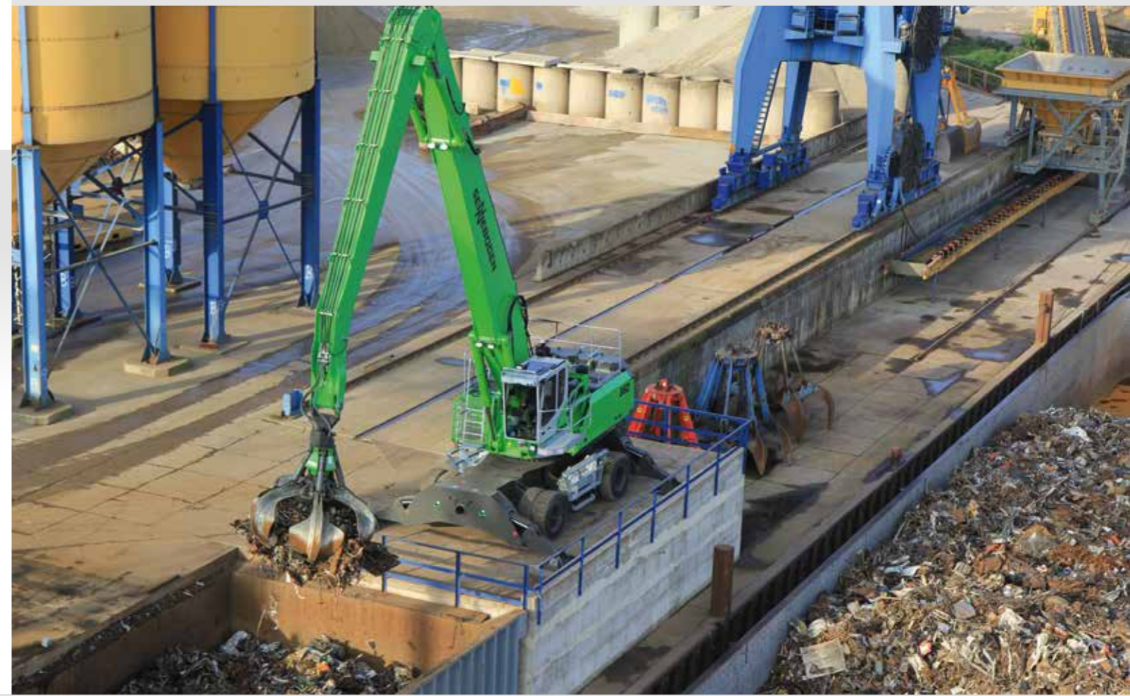
860 M - with orange peel grab - loading a ship; Germany 860 M - mit Mehrschalengreifer - Schiffsbeladung; Deutschland
