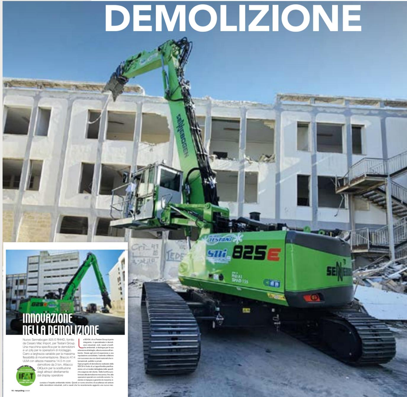
**NUOVO 825 E RHH PER TESTANI GROUP. UNA MACCHINA SPECIFICA PER LE DEMOLIZIONI E UN JOLLY PER LE OPERAZIONI DI RICICLAGGIO. CARRO A LARGHEZZA VARIABILE PER LA MASSIMA FLESSIBILITÀ DI MOVIMENTAZIONE. BRACCIO K14 ULM CON ALTEZZA MASSIMA 16 M CON DEMOLITORE DA 3 TON. ATTACCO OILQUICK PER LA SOSTITUZIONE DEGLI ATTREZZI DIRETTAMENTE DAL DISPLAY OPERATORE.**
