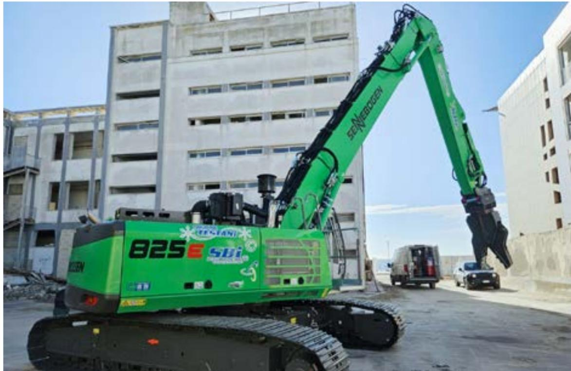
zioni, come **il grande sbraccio fondamentale nel decommissioning in altezza ed il cinematismo di un caricatore** che unito alla cabina a parallelogramma, "tiltabile" all'occorrenza, permette a Sennebogen 825 E di essere usata praticamente in ogni situazione.
