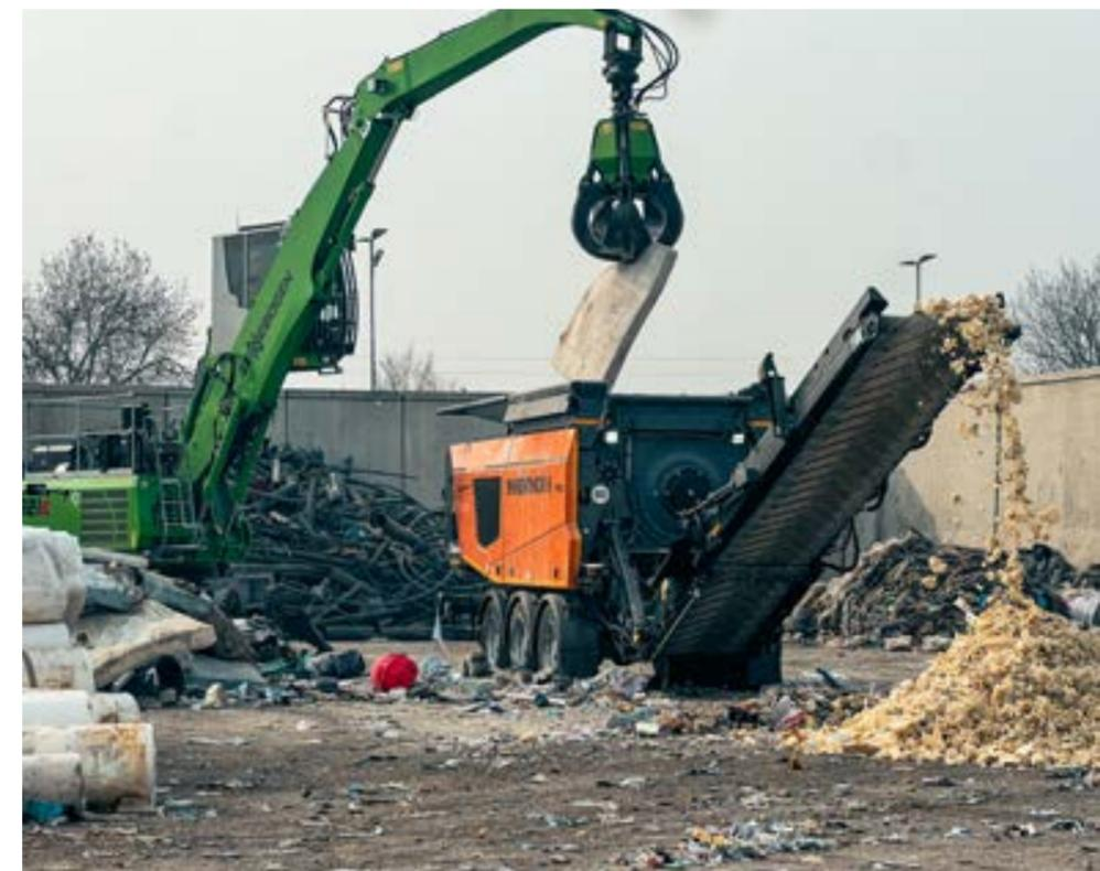
nome MO.BA. (Mobile Basket), che essendo solidale con il pettine e non fissata al telaio del tritratore (come i competitor di mercato) garantisce un movimento in base alle necessità di tritrazione. Questo assicura diversi benefici, innanzitutto viene tutelata l'integrità della macchina durante la tritrazione; infatti, il peso del materiale non viene scaricato sulla struttura della macchina con pericolo di sfondamento o torsioni, ma mantiene la rigidità necessaria per garantire una pezzatura
