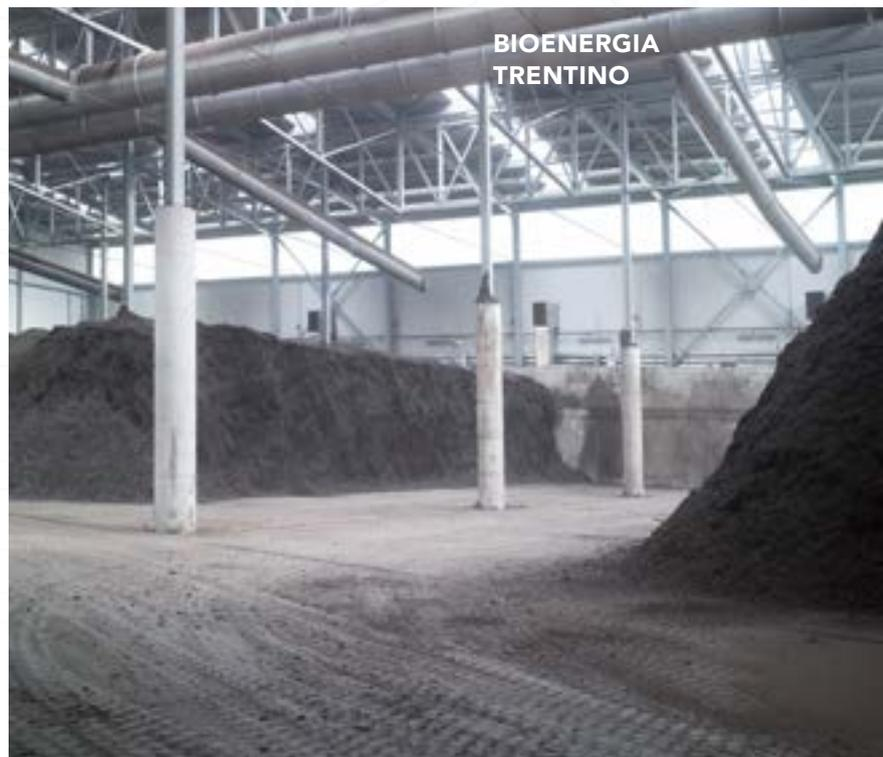
IL TRATTAMENTO AEROBICO DELLA MATRICE ORGANICA CONSENTE DI FISSARE IL METANO PRODOTTO DALLA DECOMPOSIZIONE ALL'INTERNO DEL TERRENO RIDUCENDO LE EMISSIONI DI GAS SERRA IN LINEA CON GLI OBIETTIVI ONU DI GLOBAL METHANE PLEDGE
