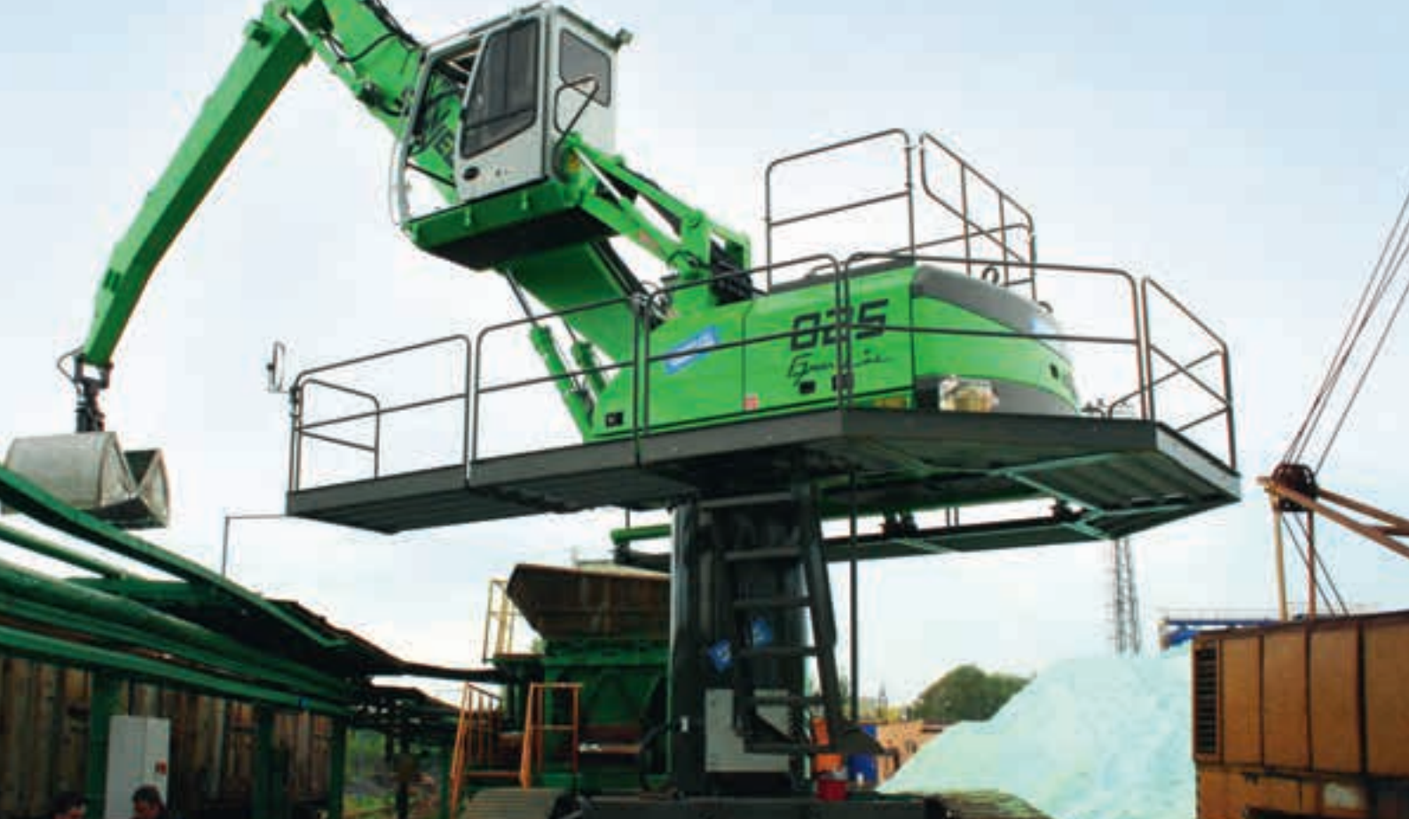
825 R - lavoro sicuro in altezza grazie ai parapetti sul carrello superiore
