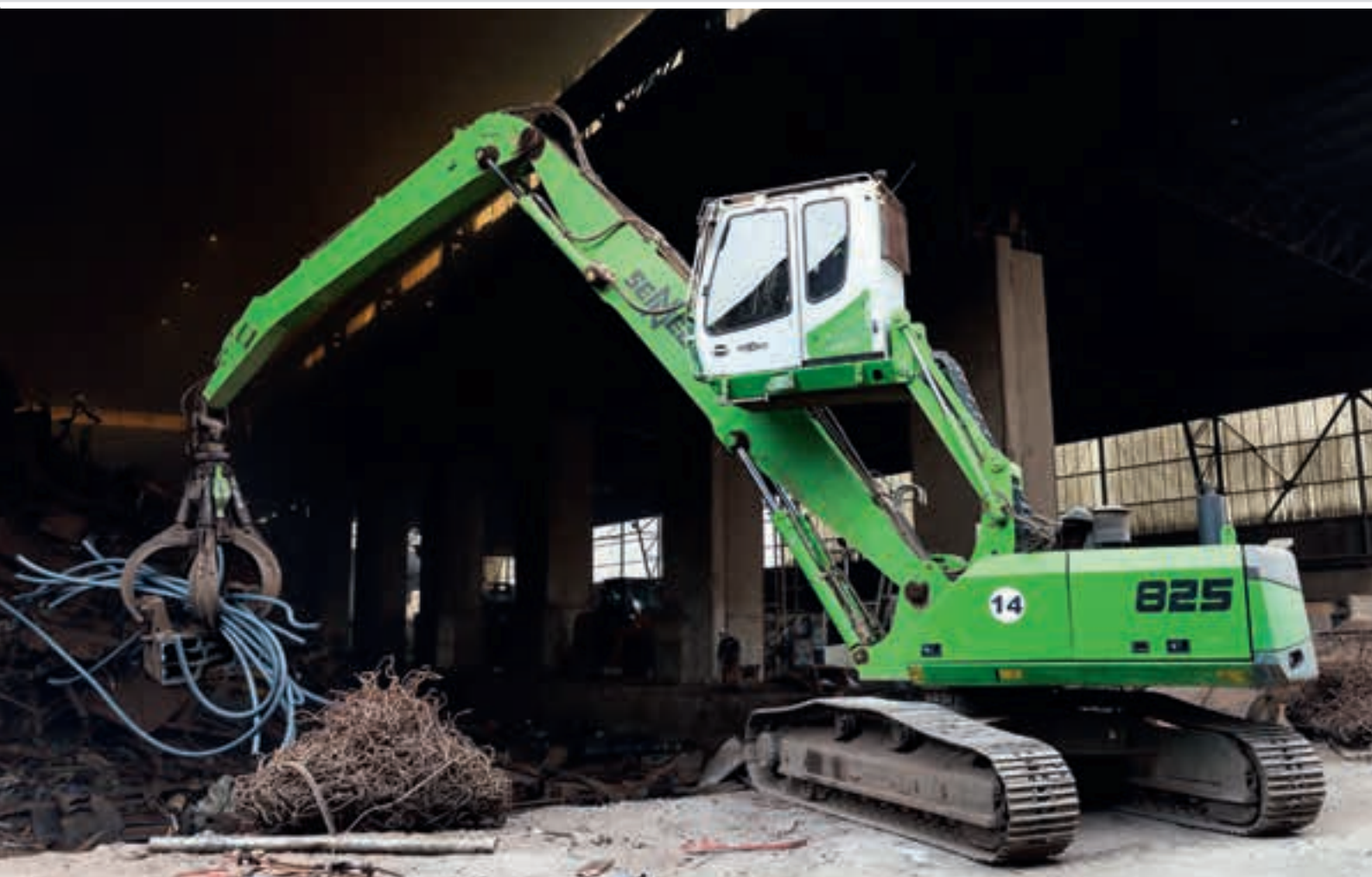
825 R - selezione di rottami di rame con pinza a polipo originale SENNEBOGEN; Turchia
