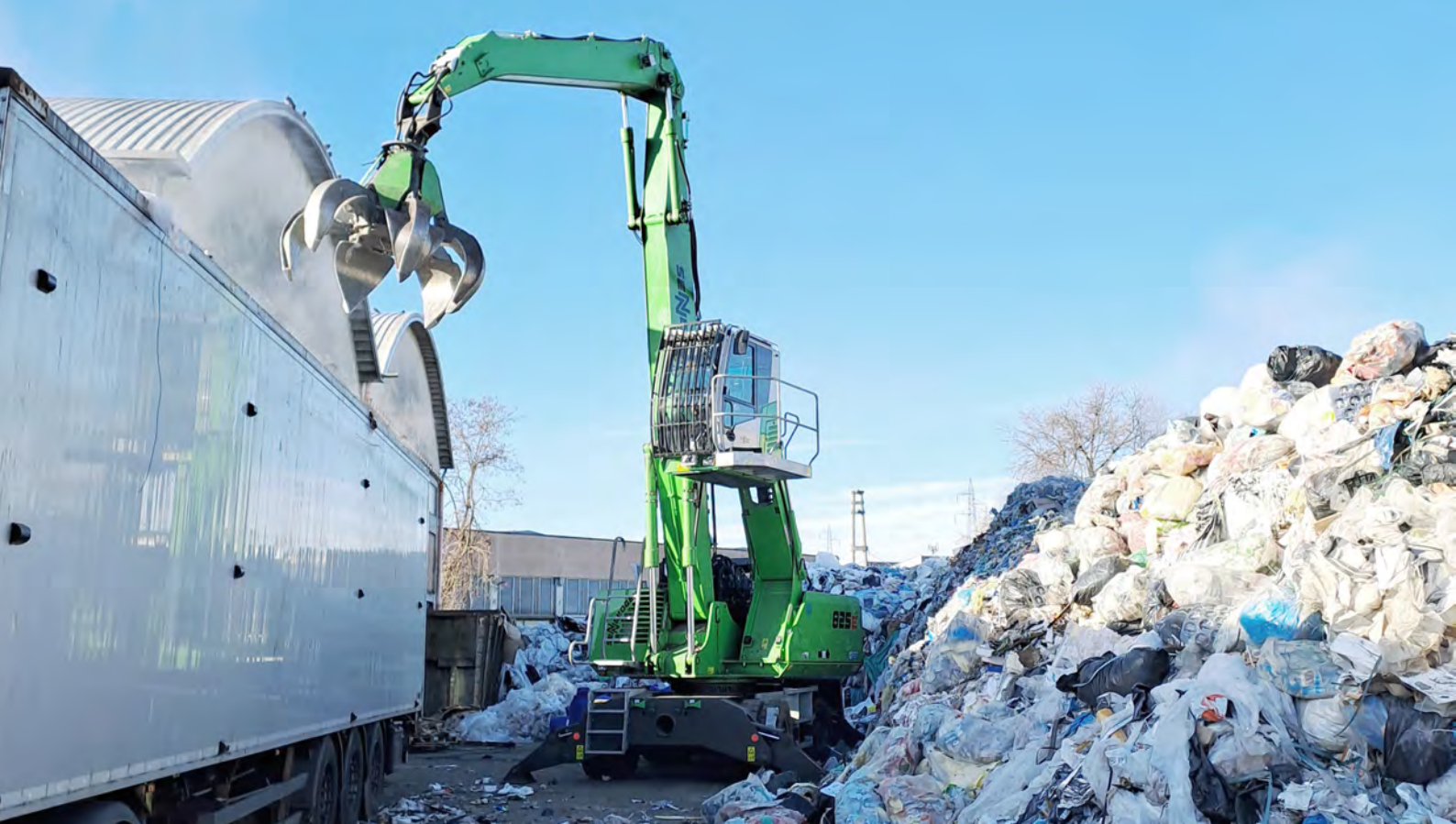
825 M - Movimentazione di rottami con pinza a polipo; Italia
