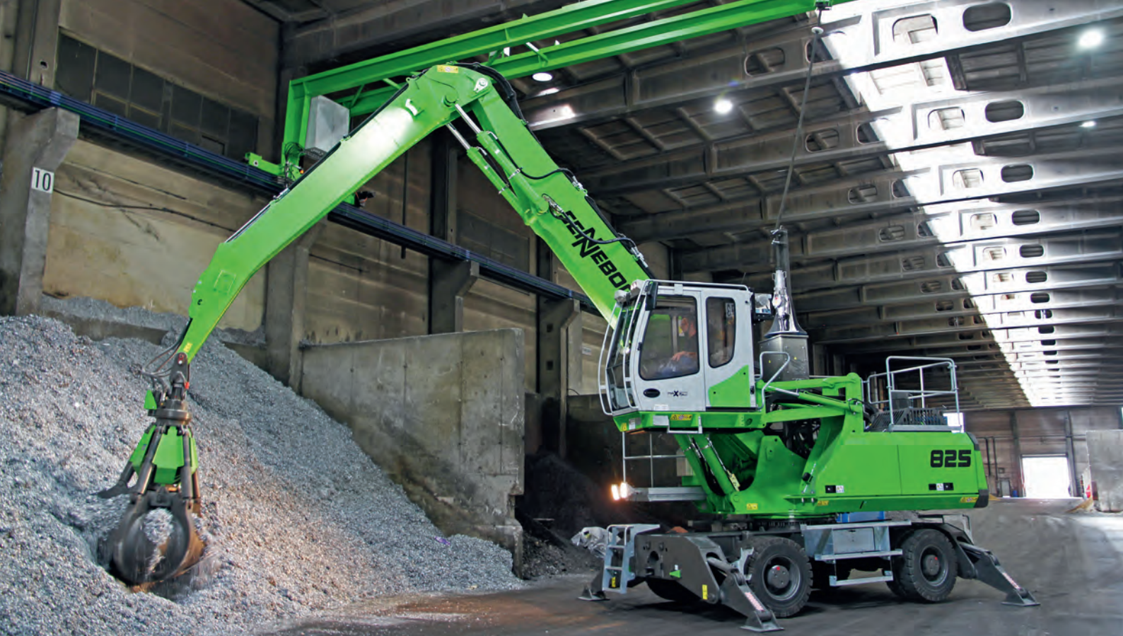
825 M Elettrico - Movimentazione di rottami per interni con alimentazione aerea; Germania
