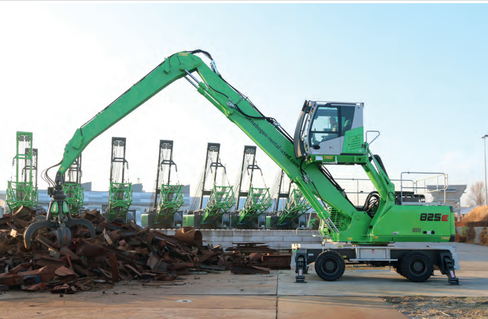
825 M - Movimentazione dei rottami con pinza a polipo originale SENNEBOGEN; Germania
