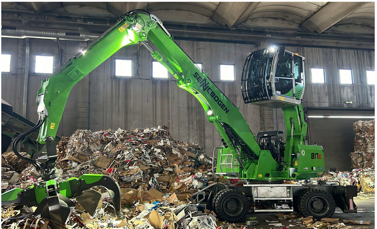
817E - ideale per l'utilizzo in ambienti chiusi/per il caricamento dei camion grazie a dimensioni compatte, cabina sollevabile e illuminazione LED
