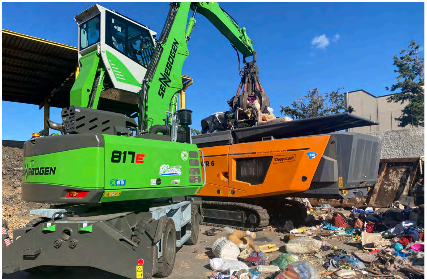
817E - moderno escavatore per la movimentazione dei materiali per lavori di smistamento rapidi e accurati nel settore del riciclaggio dei rifiuti
