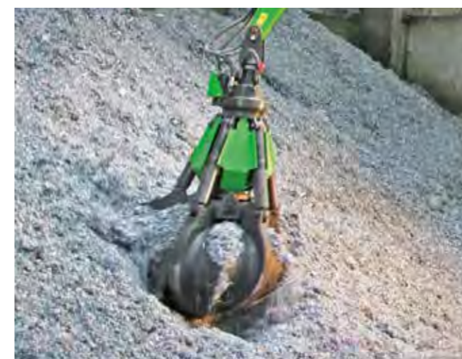
Pinza a polipo (SGM), a guscio chiuso, per es. trucioli metallici
