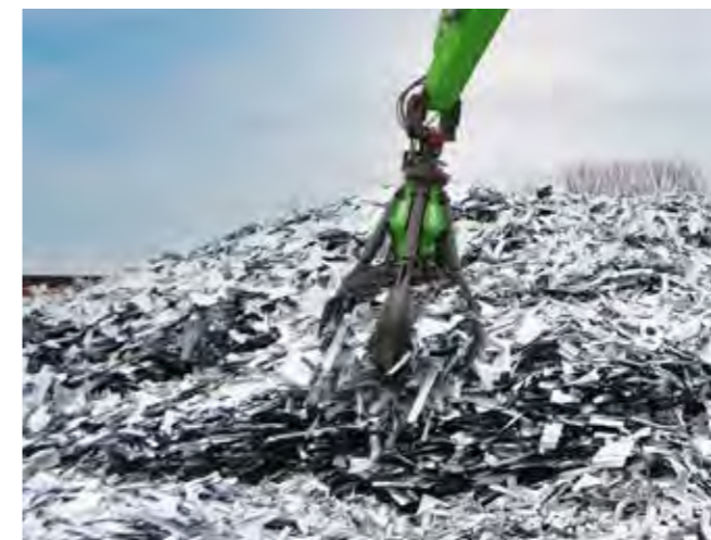
Pinza a polipo (SGM), a forma di conchiglia semiaperta, per esempio per rifiuti di lamiera
