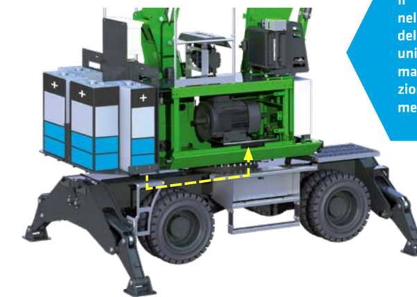
Il pacco accumulatori nella parte posteriore della macchina funge da unica fonte di energia. La macchina si muove e funziona in modo completamente autonomo.
