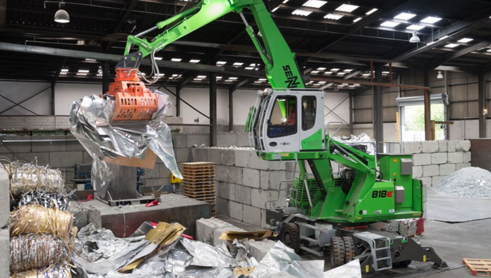
818 M - Riempimento di un'imballatrice con benna selezionatrice
