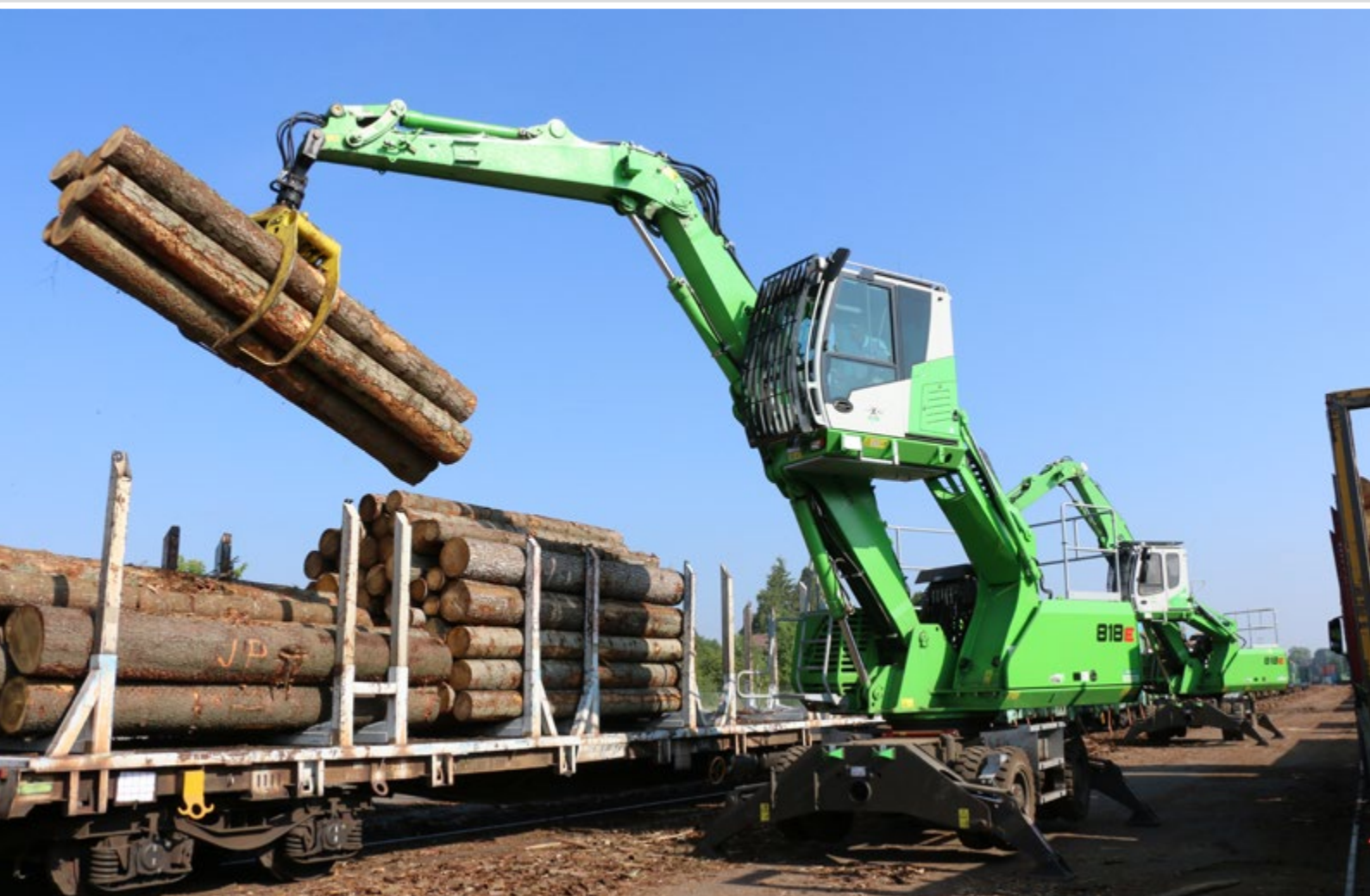
818 M - Visuale migliore durante il carico e lo svuotamento di treni, con pinza per tronchi, grazie all'innalzamento in continuo della cabina 19
